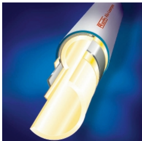
Figur 2. Här ser man tydligt uppbyggnaden av ett kompositrör: Ett inre medieförande rör av PE, ett längssvetsat aluminiumrör utan överlappning i mitten och ett uvändigt skyddsrör av PEH. (Källa: Geberit Mepla)
