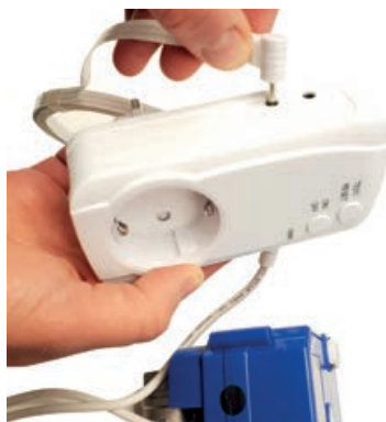
Bild 2. Vattensensorn kopplas in på vänster sida av centralenheten. (2 st sensorer kan anslutas.)
