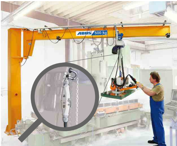
Svängkran med vakuumutrustning med extra anslutningskontakt (bild 13)
