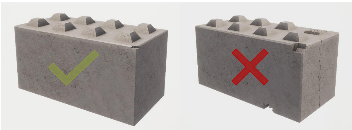
Figur 6.5e-f. Blockbedömning sett till sprickbildning samt kantstötningar.
