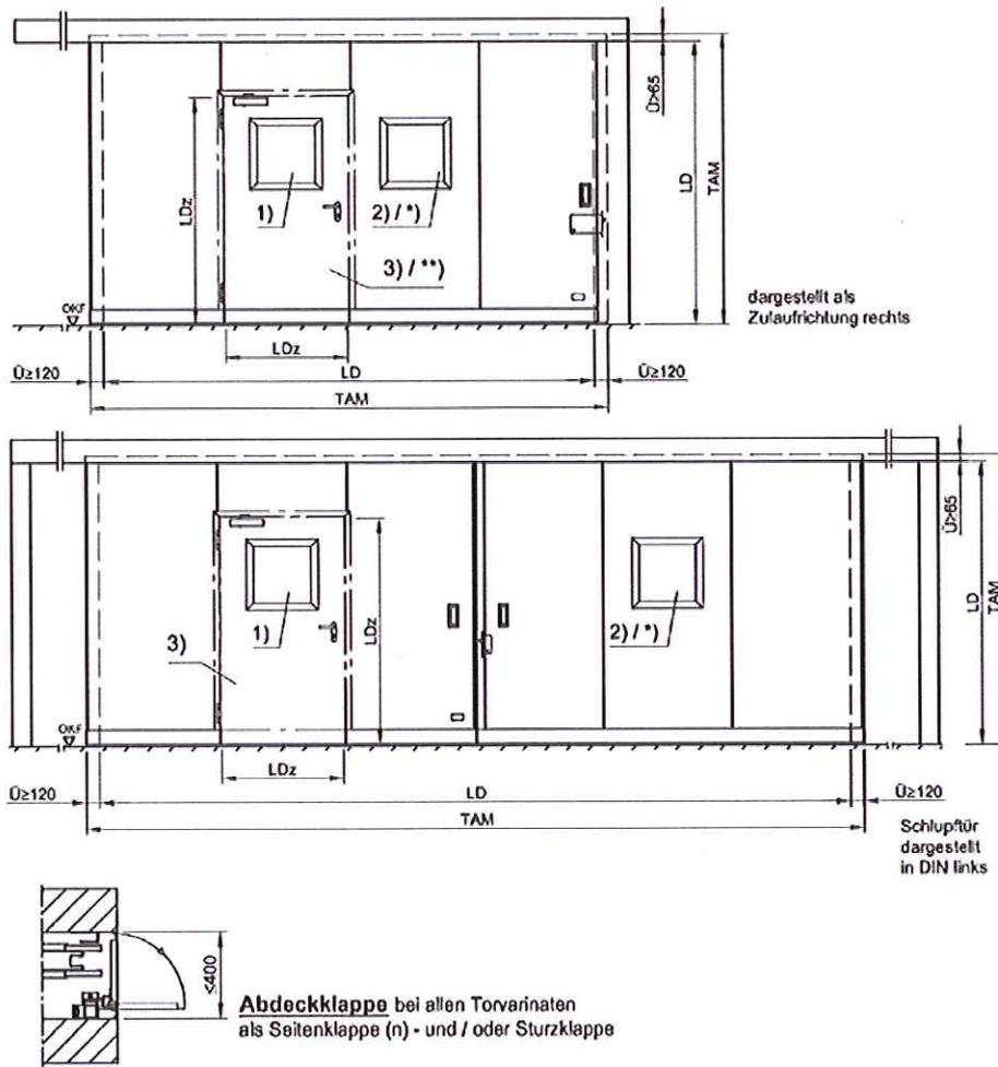
**T 90-1-RS-FSA und T 90-2-RS-FSA „Teckentrup 72 E immer mit unterer Bodendichtung ausführen. Elementstöße und Wandanschlüsse mindesten einseitig dauerelastisch versiegeln!**
