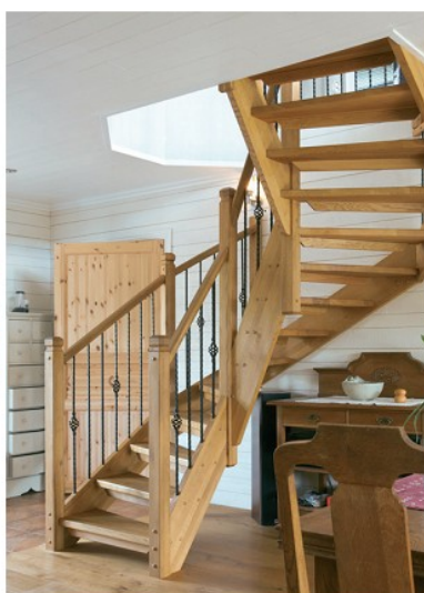
Öppen U-trappa Design Tradition i massiv ek kortstav lackad, handledare nr 2, ståndare Steel 14, Stolpe nr 1 med topp R. Valvinklädnad i massiv ek kortstav.
