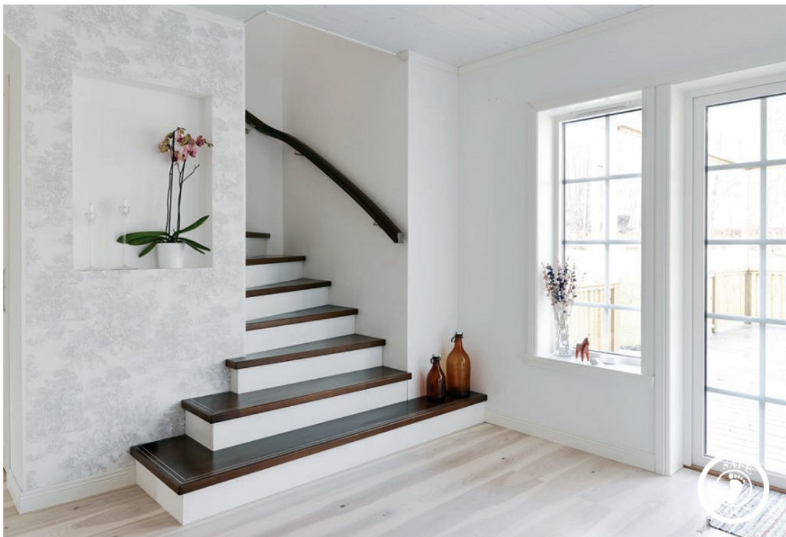
L-trappa Design Ovanpåliggande med dold vang och utvinklad trappstart, plansteg i valnötsbetsad bok och vita sättsteg. Plansteg med halkskydd/kontrastmarkering av infrästa metallskenor.
