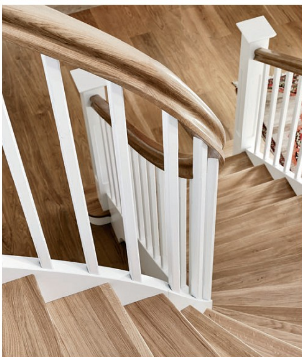
Tät L-trappa Design Tradition med plansteg och handledare (nr 3) i lackad ek helstav, vita sättsteg, vita vanger utan synliga täckplugg (underskruvslösning), ståndare Romantic Nr 12 spår 2, ändstolpar Romance med topp T, första steget utsvängt s.k. blocksteg med rundat sättsteg, radie svängt hörn s.k. krymmlingsböj.
