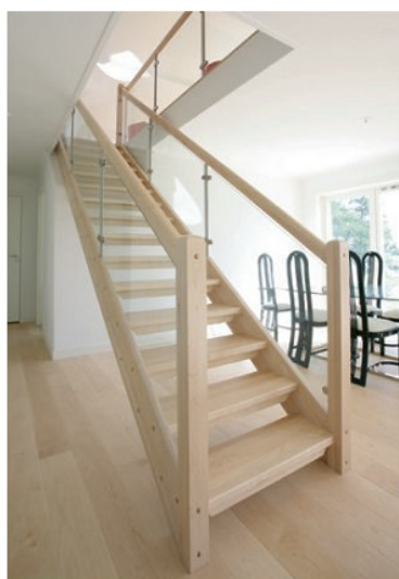
Öppen U-trappa Design Tradition i massiv ek kortstav lackad, handledare nr 2, ståndare Steel 14, Stolpe nr 1 med topp R. Valvinklädnad i massiv ek kortstav.
