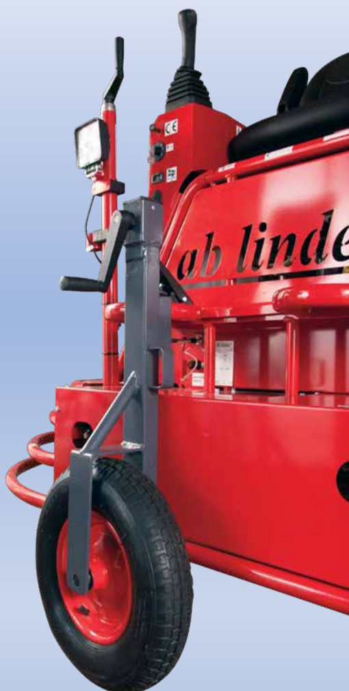
AB Lindec® Dolly Wheels monterade på en LC900H åkglättare.
