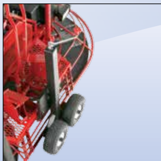
Hjulställ som tillval för enkel förflyttning av maskinen. (Skumfyllda däck som tillval)
