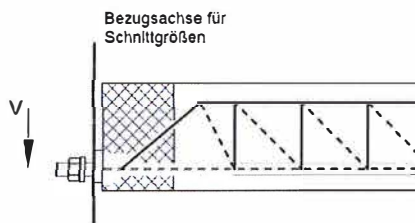
Abb. 2: Bemessungsschnitt HIT-SZV gemäß Z-15.7-336
