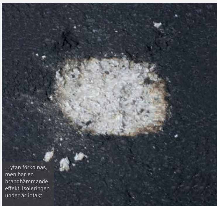
Cellulosaisolering brinner som trä, kontrollerad men säkert. I en visning behandlas cellulosa vid 1000 ° C i flera minuter.
