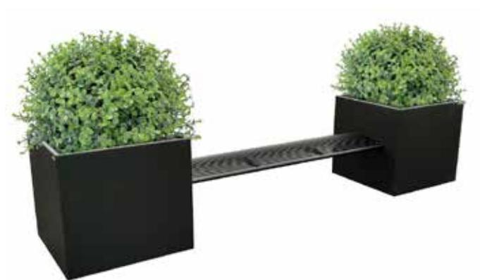
Fioriera costituita da uno scatolato in lamiera tagliato al laser e piegato. Il fondo ha saldato nella parte inferiore tubolari che fungono da piedini ed è dotato di fori per l'eliminazione dell'eccesso d'acqua. La seduta è realizzata da trafilati di acciaio saldati a supporti laterali e supporti centrali sagomati. Le parti metalliche sono zincate e verniciate.
