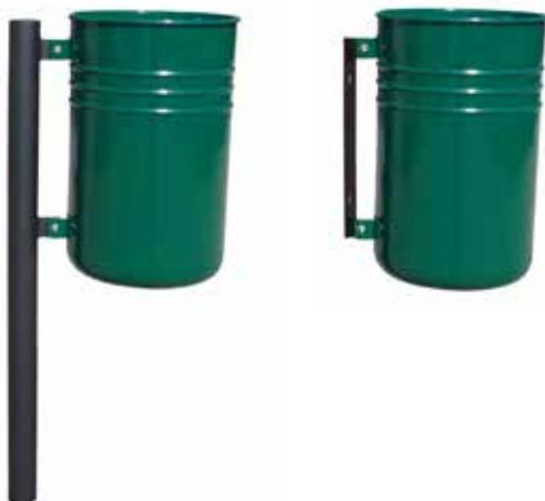
Contenitore a forma cilindrica ottenuto dalla calandratura a freddo di lamiera. La parte inferiore viene chiusa con un fondello bombato. Completo di reggisacco. Il contenitore è sostenuto da un tubolare in acciaio da inghisare o tassellare, chiuso nella parte superiore con un tappo in PVC. Tutte le parti metalliche sono zincate e verniciate. Capacità 45 lt.
