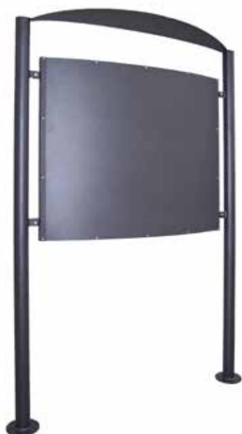
Bachecca composta da colonne portanti in acciaio da inghisare, con piastre decorative. Il telaio centrale è costituito da tubolare in ferro al quale viene rivettata una lamiera. La versione standard è con pannello bombato, ma a richiesta può essere fornita con pannello semplice.
