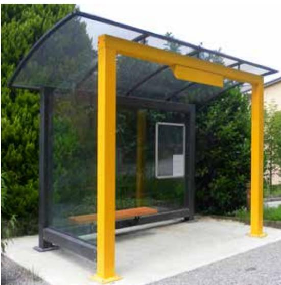
Pensilina realizzata da due portali d'acciaio. La copertura è costituita da un telaio d'acciaio sul quale viene fissato il policarbonato. La parete di fondo e una parete laterale sono realizzate da lastre di vetro, la seduta è realizzata in legno. Sulla parete di fondo può essere fissata una bacheca. L'ancoraggio al suolo avviene tramite tasselli. Tutte le parti metalliche sono zincate e verniciate.
