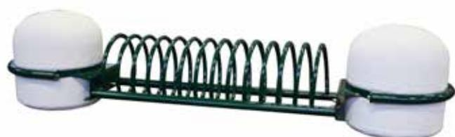
Portabici costituito da due fianchi in calcestruzzo ed una rastrelliera formata da un elemento a spirale in tubolare saldata a due tubi e a due staffe sagomate e forate a laser. I fianchi e la rastrelliera sono fissati tra di loro tramite una staffa opportunamente piegata e un archetto che circonda il basamento in calcestruzzo. Tutte le parti metalliche sono zincate e verniciate. Può essere da 3, 5 e 7 posti, ed inoltre con accostamenti in serie può fare composizione a batteria.
