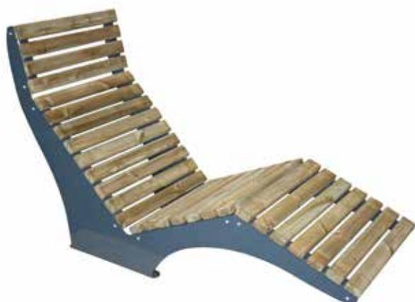
Panchina costituita da due robuste spalle laterali in acciaio tagliate con tecnologia laser con piastre base predisposte per poter fissare la panchina al suolo con tasselli. Seduta con schienale formata da doghe in pino nordico impregnate in autoclave. La seduta è fissata alle spalle tramite viti. Le parti metalliche sono zincate e verniciate.
