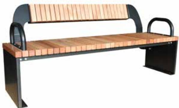
Panchina L. 1800 mm con struttura in acciaio zincato e verniciato, costituita da due supporti in lamiera con piastre base per il fissaggio con tasselli. La seduta e schienale sono formati da doghe in legno di pino nordico trattato per esterno. A richiesta può essere utilizzato legno di pregio. Può essere fornita con o senza braccioli.
