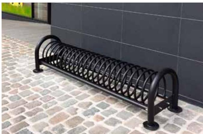
Portabici costituito da un elemento a spirale saldato a due tubolari orizzontali tondi. Alle estremità dei tubolari orizzontali sono saldate le staffe in piatto forate per il fissaggio agli archetti laterali di sostegno. I due archetti alle estremità sono in tubolare e alla base sono saldate piastre per il fissaggio a suolo tramite tasselli. Tutte le parti metalliche sono zincate e verniciate. Può essere da 5, 7 e a 9 posti. Disponibile anche con rastrelliera in inox.
