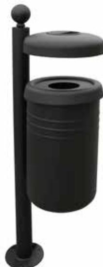
Contenitore ottenuto dalla calandratura a freddo di lamiera. La parte superiore viene bordata con un anello mentre la parte inferiore viene chiusa con un fondello bombato. L'anello superiore apribile ha la funzione di reggisacco ed ha saldato una riduzione. Il contenitore è sostenuto da un tubolare completo di coperchio con posacenere. Tutte le parti metalliche sono zincate e verniciate.
