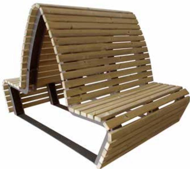
Panchina doppia L.1320 mm con schienale in legno, struttura in acciaio zincato e verniciato, formata da tre supporti tagliati al laser provvisti di base forata per il tassellamento al suolo e sulla parte superiore da una lamiera sagomata forata per il fissaggio delle doghe in legno di pino. A richiesta può essere usato legno di pregio.
