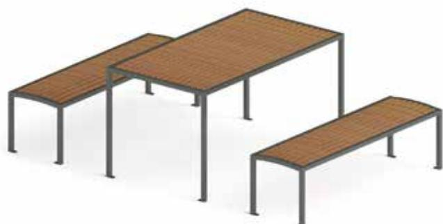
Set con struttura portante in tubolare di acciaio zincato e verniciato. La seduta e lo schienale delle panchine ed il piano del tavolo sono formate da doghe in legno di pino nordico trattato. A richiesta può essere utilizzato legno di pregio. Per dare stabilità alla seduta ed allo schienale centralmente viene fissato tramite viti un rinforzo.
