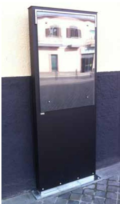
Totem in lamiera d'acciaio inox o zincata e verniciata. Fissaggio al suolo tramite zoccolo in acciaio inox con predisposizione per il tassellamento al suolo. La superficie espositiva è protetta da polycarbonato. Completo di gocciolatoio. Pannello di fondo in lamiera zincata e verniciata. A richiesta può essere monofacciale o bifacciale.
