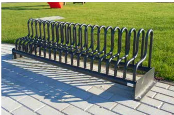
Portabici formato da rastrelliera costituita da elementi in tubolare tondo di acciaio, opportunamente piegati e saldati a due tubolari orizzontali tondi. Alle estremità dei tubolari orizzontali sono saldate le flange in piatto a forma di "L" forate per il fissaggio al suolo. Tutte le parti metalliche sono zincate e verniciate. Può essere da 3, 5, 7, 9 posti.
