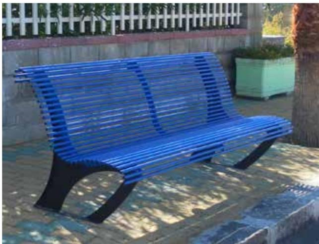
Panchina L.2000 mm costituita da due robuste spalle laterali tagliate al laser e ribordate in piatto saldato nella parte posteriore e inferiore. Seduta e schienale formati da tubolari di acciaio saldati a 3 flange sagomate al laser. I tubolari sono chiusi alle estremità. Le parti metalliche sono zincate e verniciate.
