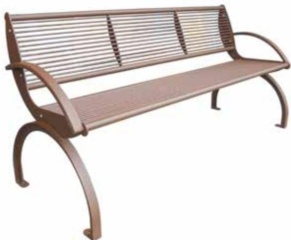
Panchina L.1675 mm costituita da 2 spalle laterali formate da una flangia sagomata al laser e saldata su un arco in piatto; predisposta per il fissaggio al suolo con tasselli. Seduta e schienale formati da trafilati di acciaio e tubolari saldati a 2 supporti laterali e 2 supporti centrali completa di braccioli in tubolare. Le parti metalliche sono zincate e verniciate.
