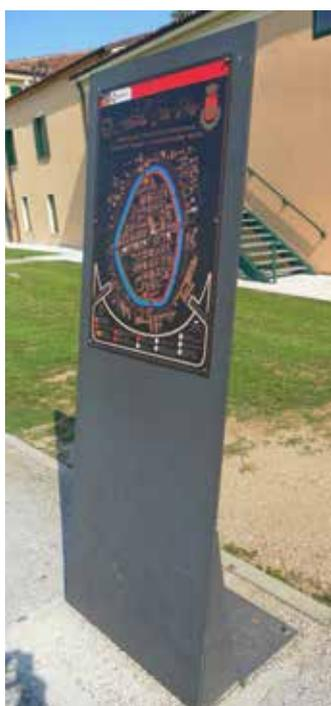
Leggio ricavato da lamiera in acciaio piegata per ricavare una base di appoggio per il tassellamento al suolo. A seconda dell'altezza vengono saldati dei pastorali di rinforzo. Le scritte possono essere serigrafate su un pannello in polietilene trasparente o su un pannello in rame e applicato al leggio tramite viti o rivetti. Struttura in acciaio zincato e verniciato. A richiesta può essere realizzato in acciaio corten.
