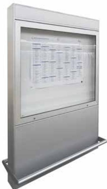
Bacheca realizzata con un telaio interno di struttura molto robusto in acciaio zincato e verniciato e rivestito in profili di alluminio. Le ante sono in alluminio a ribalta verso l'alto, sostenute da pistoncini ad aria. Può essere monofacciale o bifacciale e può essere dotata a richiesta di poggiapiedi. Disponibile anche nella versione a muro e dotata di illuminazione. Sulla anta viene montato un vetro temperato e con guaine di protezione contro le infiltrazioni.
