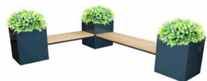
Fioriera costituita da uno scatolato in lamiera tagliato al laser e piegato. Il fondo ha saldato nella parte inferiore tubolari che fungono da piedini ed è dotato di fori per l'eliminazione dell'eccesso d'acqua. La seduta è realizzata da doghe in legno di pino. A richiesta può essere utilizzato legno di pregio. Le parti metalliche sono zincate e verniciate.
