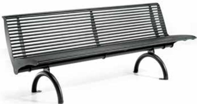
Panchina L. 1980 mm realizzata interamente in acciaio zincato e verniciato. La seduta e lo schienale sono composte da tubolari saldati a tre sostegni sagomati a laser. Alle estremità laterali della panchina sono fissati i due supporti in tubolare sagomati ad arco.
