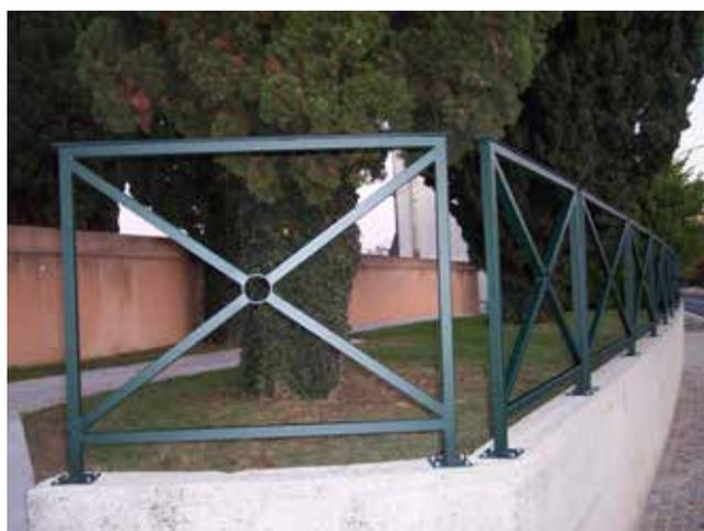
Barriera realizzata da un telaio perimetrale e crociera centrale con elementi in tubolare quadro. Il nodo centrale è realizzato con un anello in tubo. La barriera è fornita di "corrimano" in acciaio mezzotondo. Tutte le parti metalliche sono zincate e verniciate. Può essere da inghisare o da tassellare.
