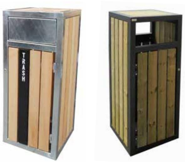
Cestino costituito da una struttura metallica realizzata da tubolare quadro opportunamente tagliato e saldato. Alla struttura sono saldati dei piatti forati per il fissaggio delle doghe in legno trattate per l'esterno. La parte superiore può essere fornita con porta apribile o senza, con maniglia o senza. Tutte le parti metalliche sono zincate e verniciate. A richiesta può essere fornito con posacenere e con scritte identificative della raccolta differenziata. Capacità 110 lt.
