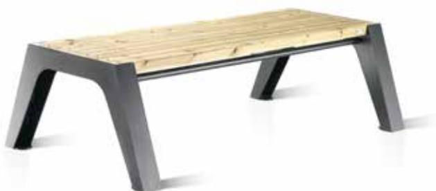
Panchina L.1690 mm costituita da supporti in acciaio zincato e verniciato. La seduta è composta da doghe in pino nordico trattato. Le piastre base sulle spalle laterali sono predisposte di foro per il fissaggio al suolo tramite tasselli.
