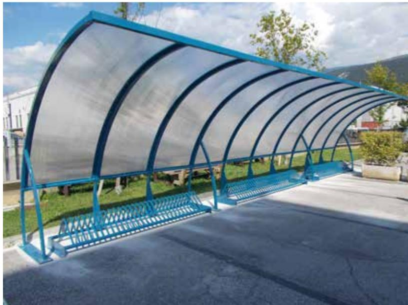
Pensilina copri biciclette e motociclette, ad arco in tubolare rettangolare resistente alle normali precipitazioni atmosferiche. Posizionabile a batteria, la copertura è per due terzi dotata di schermatura in polycarbonato alveolare e non prevede grondaia. Struttura zincata e verniciata. Il portabici è fornito a parte.
