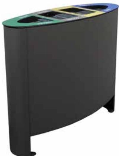
Cestino in acciaio zincato e verniciato, di forma ellittica per la raccolta differenziata di 4 tipi di rifiuto. Supporti laterali con piastre base per il fissaggio a pavimento. Il cestino è fornito di quattro contenitori interni in acciaio. Ogni contenitore interno è identificato da una fascia colorata con scritte identificative della raccolta. Il coperchio si può aprire sbloccando la serratura con la chiave universale fornita. Può essere realizzato anche a tre contenitori.
