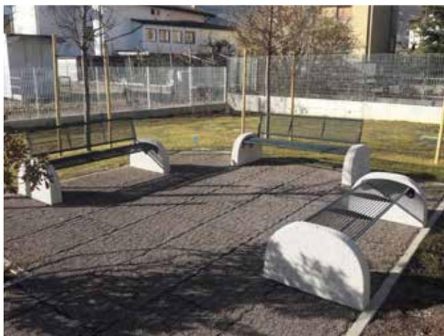
Panchina L.1863 mm costituita da fianchi laterali in cemento. Seduta e schienale sono formati da trafilati di acciaio saldati a supporti laterali e centrali sagomati. I supporti laterali sono fissati ai fianchi in acciaio opportunamente forati per il fissaggio ai cementi. Tutte le parti metalliche sono zincate e verniciate.
