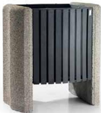
Cestino costituito da una struttura metallica fissata tramite viti ai due fianchi in cemento. Il contenitore interno in lamiera zincata e verniciata è provvisto di maniglie laterali per l'estrazione. Su richiesta può essere fornito con coperchio superiore. Le parti metalliche sono in acciaio zincato e verniciato. Capacità 80 lt.
