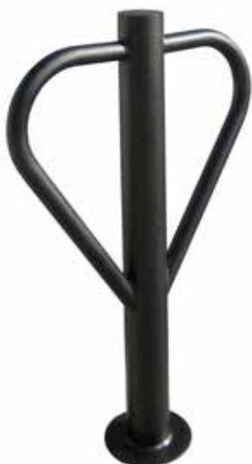
Portabici realizzato in tubolare d'acciaio al quale vengono saldate due "maniglie" in tubo tondo sagomato per assicurare la bicicletta. Il portabici può essere fornito da inghisare o predisposto con piastra con fori per il fissaggio al suolo tramite tasselli. Le parti metalliche sono zincate e verniciate.
