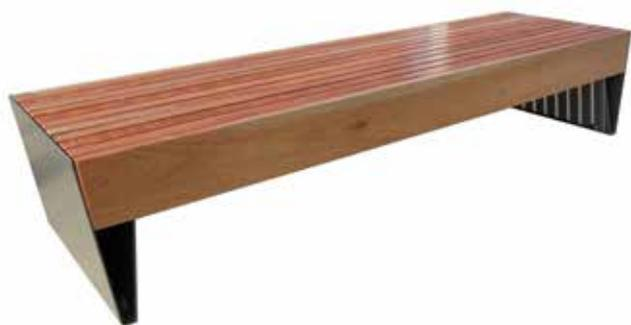
Panchina L. 2300 mm con struttura in acciaio zincato e verniciato. Nella parte inferiore i fianchi sono provvisti di fori per il tassellamento a terra, e nella parte superiore sono già predisposti i fori dove andranno fissate le doghe in legno di pregio trattato per esterni.
