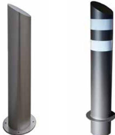
Dissuasore realizzato in tubolare d'acciaio inox o zincato e verniciato chiuso all'estremità superiore da una lamiera sagomata al laser e saldata che può essere inclinata o dritta. Il dissuasore viene fornito con piastra base con fori per il tassellamento, oppure direttamente da inghisare.
