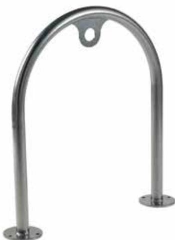
Portabici realizzato in tubolare sagomato ad arco e piastre base con fori per il fissaggio al suolo tramite tasselli. L'elemento centrale è realizzato in lamiera tagliata al laser per poter assicurare la bicicletta sul telaio. Può essere fornito anche nella versione da inghisare. Le parti metalliche sono in acciaio inox o in acciaio zincato e verniciato.
