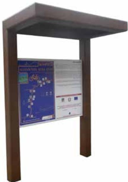
Bacheca realizzata in tubolare a sezione quadra con angoli arrotondati. Sul tetto viene saldata una lamiera piana mentre sui due montanti delle piastrelle, a cui vengono poi fissati i traversi in alluminio estruso che sostengono il pannello informativo. Struttura in acciaio zincato e verniciato, disponibile anche nella versione inox e corten.
