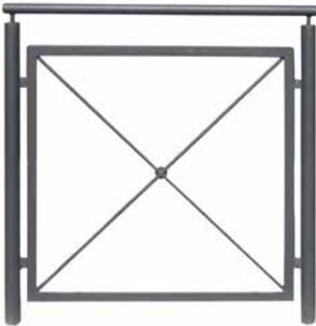
Barriera realizzata con supporti e traverso superiore in tubolare saldati tra di loro. Il disegno interno è realizzato da cornice in profilo a "L" e croce in tondini con saldato al centro una piastrina. Tutte le parti metalliche sono zincate e verniciate. La barriera può essere fornita da inghisare o da tassellare.
