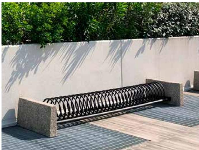
Portabici costituito da un elemento a spirale saldato a due tubolari orizzontali tondi. Alle estremità dei tubolari orizzontali sono saldate le doppie staffe in piatto forate per il fissaggio ai muretti laterali di sostegno in calcestruzzo mascherate sotto coperchio. Tutte le parti metalliche sono zincate e verniciate. Può essere da 5, 7 e a 9 posti. Disponibile anche nella versione inox.
