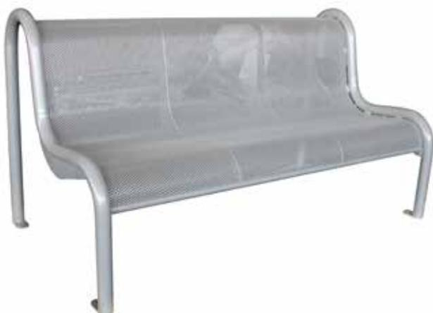
Panchina L.1553 mm interamente realizzata in acciaio zincato e verniciato. Fianchi realizzati in tubolare opportunamente piegati con un rinforzo tagliato a laser e con piastre base per il tassellamento al suolo. La seduta e lo schienale sono un unico elemento composto da una lamiera forata calandrata, con rinforzi in lamiera tagliati a laser e due supporti in tubolare. Seduta fissata ai fianchi tramite viti.
