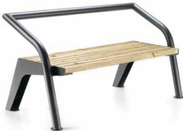
Panchina L.1870 mm costituita da due spalle laterali in acciaio sagomate con tecnologia laser. Lo schienale e i sostegni laterali sono realizzati con un unico tubolare di acciaio. La seduta è composta da doghe in legno di pino nordico trattato. Le piastre base sui sostegni laterali sono predisposte di foro per il fissaggio al suolo tramite tasselli. Tutte le parti metalliche sono zincate e verniciate.
