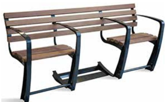
Panchina L.1800 mm con struttura in acciaio zincato e verniciato costituita da due supporti in piatto rinforzati da un profilo tagliato a laser con piastre base per il fissaggio con tasselli. La seduta e lo schienale sono formati da doghe in pino nordico trattato per esterno. A richiesta può essere utilizzato legno di pregio.
