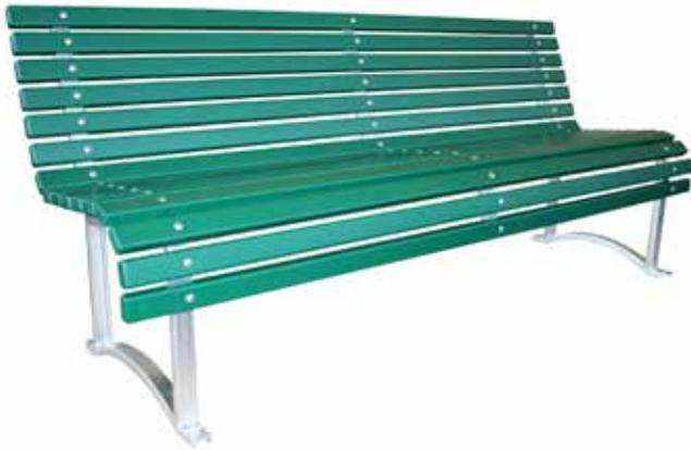
Panchina L.1900 mm con struttura in acciaio zincato a caldo costituita da struttura portante interamente realizzata in profilo ad "U" opportunamente sagomato, fissaggio al suolo con tasselli. La seduta e lo schienale sono formati da doghe in pino nordico verniciato.
