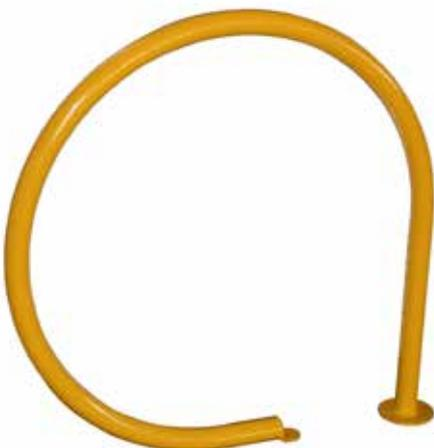
Portabici ad 1-2 posti realizzato mediante calandratura di tubolare in acciaio. Il portabici viene fornito con piastra di base per il tassellamento al suolo o su richiesta da inghisare con piastre decorative per coprire il foro. Realizzato in acciaio zincato e verniciato. Si può installare singolarmente o a batteria.
