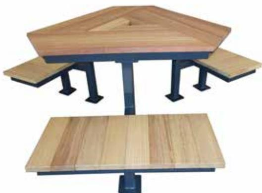
Set composto da una struttura in acciaio zincato e verniciato formata da supporti in tubolare quadro. Ai fianchi vengono saldate piastre con fori per il fissaggio al suolo tramite tasselli. La seduta ed il piano del tavolo sono composti da doghe di legno in pino nordico. A richiesta può essere utilizzato legno di pregio.
