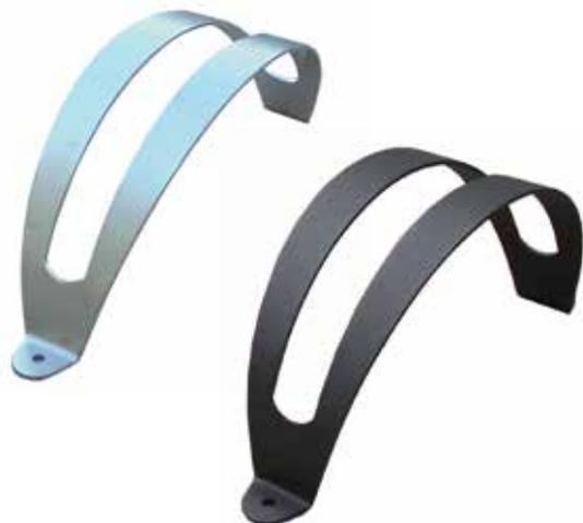
Portabici realizzato in lamiera opportunamente calandrata, tagliato con tecnologia laser nella parte centrale dove andrà alloggiata la ruota della bicicletta. Il portabici viene fornito con piastre base per il fissaggio al suolo con tasselli. Le parti metalliche sono zincate e verniciate. Su richiesta può essere realizzato in acciaio inox.
