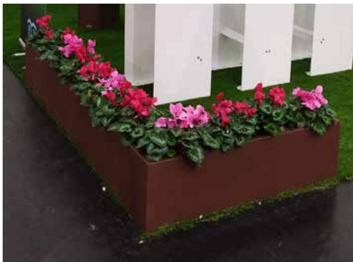
Fioriera costituita da uno scatolato in lamiera tagliato al laser e piegato. La parte superiore è ricavata dalla piega della lamiera in modo da formare una cornice. Il fondo ha saldato nella parte inferiore 4 pezzi di tubolare che fungono da piedini ed è dotato di fori per l'eliminazione dell'eccesso d'acqua. Le parti metalliche sono zincate e verniciate.
