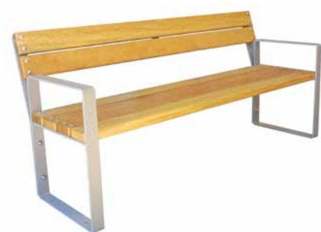
Panchina L.1800 mm con supporti piegati e contornati a formare un rettangolo. Sulla base dei supporti ci sono dei fori per il tassellamento al suolo. Seduta e schienale sono formati da doghe in legno di pino. A richiesta può essere utilizzato legno di pregio. La struttura può essere fornita in acciaio zincato e verniciato o in acciaio inox.
