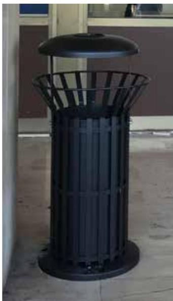
Cestino costituito da raggi in piatto d'acciaio opportunamente piegati e uniti con saldatura. Il coperchio ribaltabile è completo di posacenere. La base può essere in cemento o in metallo. Il cestino è fornito con contenitore interno ottenuto dalla calandratura di lamiera. La parte inferiore viene chiusa con un fondello forato per l'eventuale scolo di acqua meteorica o di periodica pulizia. Tutte le parti metalliche sono zincate e verniciate. Capacità 63 lt.
