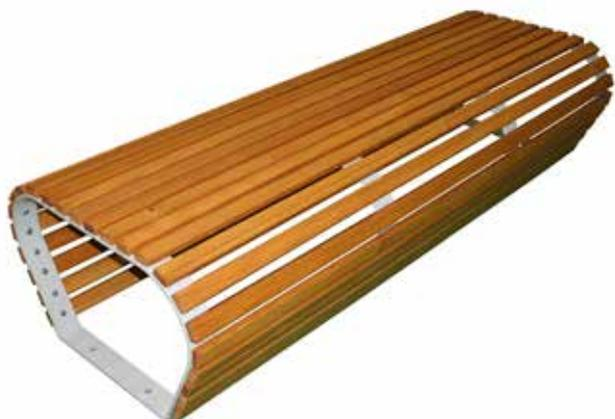
Panchina L.1750 mm piana, struttura in acciaio zincato e verniciato (a richiesta può essere fornita in acciaio inox) con fori sulla piastra base per il fissaggio al suolo con tasselli. Seduta realizzata da doghe in legno di pino. A richiesta può essere usato legno di pregio.
