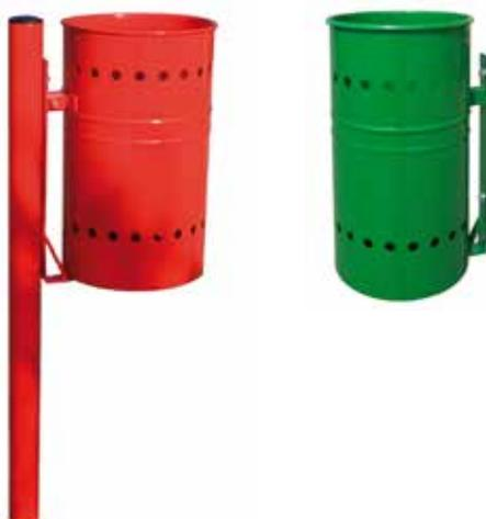
Contenitore di forma cilindrica in lamiera forata bordata nella parte superiore e sostegno in tubolare d'acciaio zincato e verniciato, da inghisare, chiuso nella parte superiore con un tappo in PVC. Il contenitore è fissato al palo di sostegno attraverso una staffa in acciaio. Tutte le parti metalliche sono zincate e verniciate. Capacità 25 lt.
