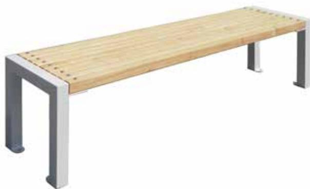
Panchina L. 1800 mm con struttura portante in tubolare in acciaio zincato e verniciato. La seduta è formata da doghe in legno di pino nordico trattato. A richiesta può essere utilizzato legno di pregio. Per dare stabilità alla seduta, centralmente viene fissato tramite viti un rinforzo.
