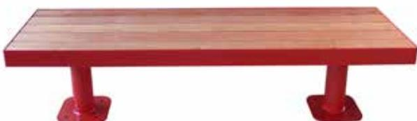
Panchina L. 1800 mm in acciaio inox o zincato e verniciato. Struttura con supporti in tubolare con piastra base forata per il fissaggio al suolo con tasselli o senza per il fissaggio tramite cementazione. Seduta con doghe in legno di pino. A richiesta può essere usato legno di pregio.
