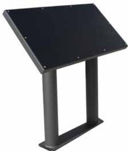
Leggio composto da due supporti in tubo tondo, saldati al sovrastante telaio in tubo quadro, sul quale viene rivettato il pannello in lamiera o alluminio. Le scritte (a richiesta) possono essere serigrafate sul pannello e applicate al leggio. Il leggio può essere fornito da inghisare o con piastra forata e saldata alla base per il tassellamento al suolo. Struttura in acciaio zincato e verniciato.
