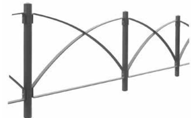
Barriera realizzata da due sostegni in tubolare di acciaio. La flangia alla base può essere senza fori come copriforo per la versione da inghisare o con fori per fissaggio al suolo tramite tasselli. Pannellatura realizzata da crociera in piatto. La barriera può essere fornita modulare o singola. Le parti metalliche sono zincate e verniciate
