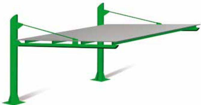
Copertura per auto componibile a moduli, realizzata da colonne portanti in tubolare di acciaio. Il puntone in tubolare di acciaio è incernierato alla colonna e sostenuto dal tirante. La copertura è sostenuta da 4 profili omega con funzione anche di collegamento tra le colonne portanti e può essere in lamiera grecata preverniciata o in lamiera coibentata. La struttura è fissata al suolo con piastre base. Tutte le parti metalliche sono zincate e a richiesta possono essere verniciate.
