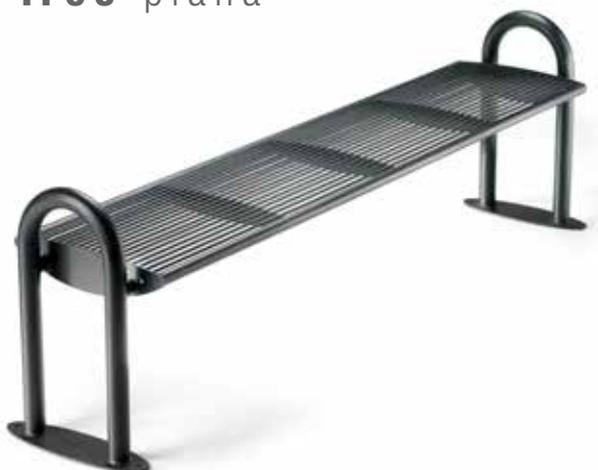
Panchina L.1786 mm piana costituita da 2 spalle laterali formate da una flangia sagomata al laser e saldata su un arco in tubolare; predisposizione per il fissaggio al suolo con tasselli. Seduta formata da trafilati di acciaio e tubolari saldati a 2 supporti laterali e 2 supporti centrali. Le parti metalliche sono zincate e verniciate.
