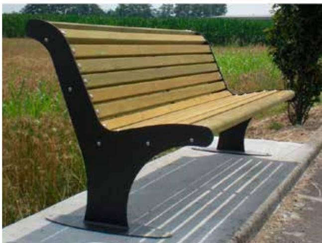
Panchina L.1800 mm costituita da due robuste spalle laterali in acciaio tagliate al laser e saldate su basi di forma ellittica predisposte per poter fissare la panchina al suolo con tasselli. Seduta con schienale formata da doghe in pino nordico fissate su tre supporti in piatto. La seduta è fissata alle spalle tramite viti in inox. Le parti metalliche sono zincate e verniciate.
