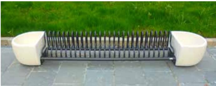
Portabici formato da rastrelliera costituita da elementi in tubolare tondo di acciaio, opportunamente piegati e saldati a due tubolari orizzontali tondi. Alle estremità dei tubolari orizzontali sono saldate le flange in piatto forate per il fissaggio alle fioriere laterali di sostegno in calcestruzzo. Tutte le parti metalliche sono zincate e verniciate. Può essere da 3, 5, 7 posti.
