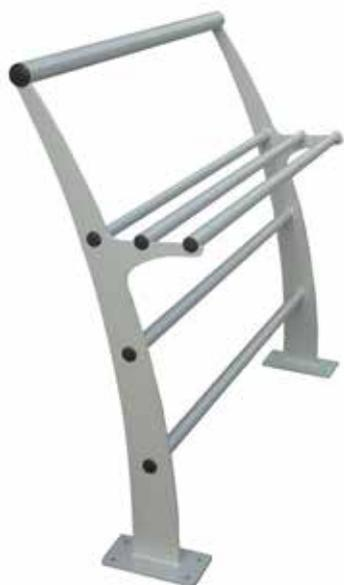
La barriera/panchina viene realizzata in acciaio inox o in acciaio zincato e verniciato. E' composta da due o tre montanti in lamiera tagliata al laser e da tubolari che vanno a costituire lo schienale, la seduta ed i poggia piedi. La struttura è da inghisare o da tassellare.
