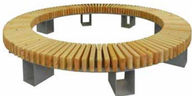
Panchina realizzata con struttura in tubolare rettangolare. Nella parte superiore dei supporti è fissata la seduta formata da doghe in pino nordico. A richiesta può essere usato legno di pregio. La parte inferiore è forata per il fissaggio al suolo. Tutte le parti metalliche sono zincate e verniciate.
