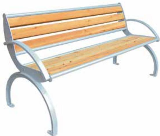
Panchina L. 1675 mm costituita da due spalle laterali formate da una flangia sagomata al laser, saldata su un arco in profilo a "T" con piastrine alla base per il fissaggio al suolo con tasselli. La seduta e lo schienale sono realizzati in legno di pino. A richiesta può essere utilizzato legno di pregio. Tutte le parti metalliche sono zincate e verniciate.
