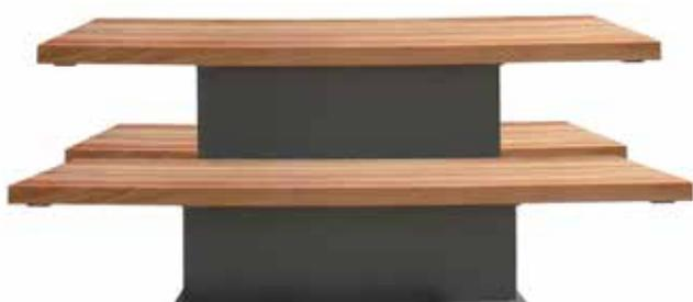
Set L.2300 mm con struttura portante in acciaio zincato e verniciato. Il supporto del tavolo e delle panchine è costituito da lamiera saldata assieme alla piastra base forata per il fissaggio al suolo con tasselli. Nella parte superiore dei supporti ci sono gli appositi fori per il fissaggio delle doghe in legno. Le sedute ed il piano del tavolo sono formati da doghe in legno di pregio.
