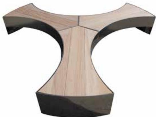
Panchina L.1700 mm a settori con possibilità di giunzione l'uno con l'altro fino ad un massimo di tre. Rinforzata con tubi rettangolari ed assemblata tramite saldatura. Le doghe sono ricavate da tavola di legno pregiato inserita in apposito sostegno e fissata a scomparsa. Può essere dotata al centro di fioriera. Struttura in acciaio inox o in acciaio zincato e verniciato.
