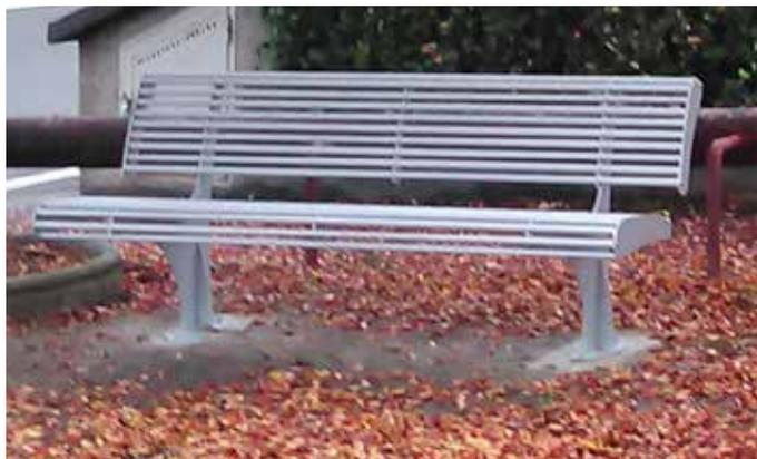
Panchina L.1800 mm in acciaio zincato e verniciato o in acciaio inox. Seduta e schienale composti da trafilati in tubolare saldati a sostegni in lamiera sagomati e chiusi da flange di chiusura tagliate con tecnologia laser. I due supporti possono essere predisposti per il fissaggio al suolo con tasselli o da inghisare.
