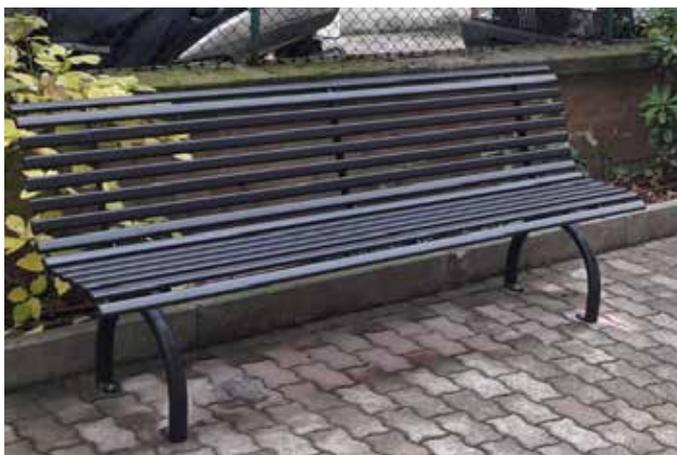
Panchina L.2000 mm realizzata interamente in acciaio zincato e verniciato. La seduta e lo schienale sono composti da tubi ovali chiusi alle estremità da tappi in PVC, saldati a tre sostegni in lamiera sagomati con tecnologia laser. I due supporti in tubolare sono sagomati ad arco e fissati al traverso centrale tramite viti, sono forniti di piastrina per fissaggio al suolo.
