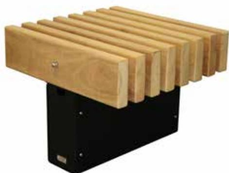
Panchina L. 560 x P. 560 mm realizzata con struttura in tubolare rettangolare. Nella parte superiore del supporto è fissata la seduta formata da doghe in legno di pino. A richiesta può essere usato legno di pregio. La parte inferiore è forata per il fissaggio al suolo. Tutte le parti metalliche sono zincate e verniciate.
