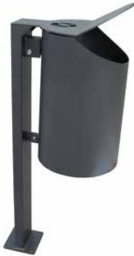
Contenitore ottenuto dalla calandratura a freddo di lamiera. Viene fornito completo di anello reggi-sacco. Nella parte superiore è fornito di coperchio in lamiera piegato nella parte frontale per l'introduzione dei rifiuti e completo di posacenere. Il contenitore è fissato a un sostegno in tubolare rettangolare di acciaio per il fissaggio con tasselli, inghisaggio o a muro. Tutte le parti metalliche sono zincate e verniciate. Capacità 45 lt.
