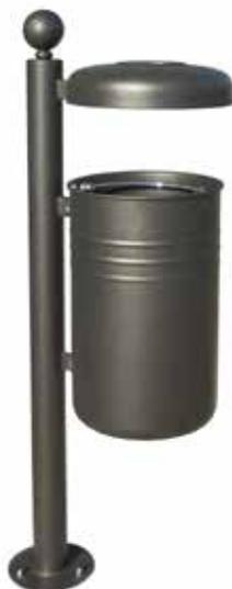
Contenitore ottenuto dalla calandratura a freddo di lamiera. La parte superiore viene bordata con un anello mentre la parte inferiore viene chiusa con un fondello bombato completo di reggi-sacco. Il contenitore è sostenuto da un tubolare completo di coperchio con posacenere. Tutte le parti metalliche sono zincate e verniciate.
