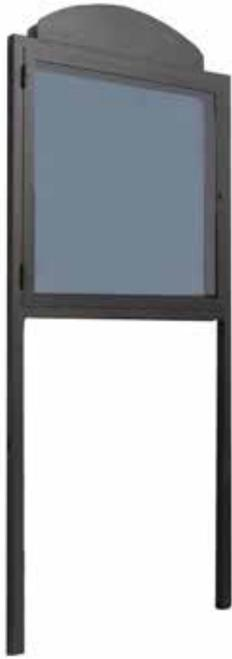
Bachecca realizzata con un telaio in tubolare d'acciaio a sezione quadra, con anta apribile in profilo di alluminio estruso, vetro antifondamento stratificato e chiusura con serratura a chiave universale. Il pannello di fondo è costituito da una lamiera in acciaio zincato e verniciato. La bachecca è inoltre dotata di un portalogò in lamiera. Tutte le parti metalliche sono zincate e verniciate.
