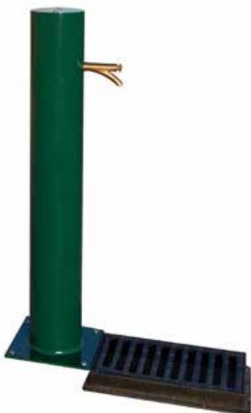
Fontana costituita da una struttura in tubolare d'acciaio tondo chiusa nella parte superiore da un tappo in acciaio. Alla base è saldata una piastra quadrata predisposta con fori per il fissaggio tramite tasselli. Tutte le parti metalliche sono zincate e verniciate. Il rubinetto in ottone nichelato è del tipo a pulsante frontale con molla di ritorno. La caditoia è interamente in ghisa verniciata.
