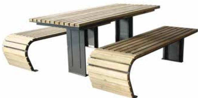
Set L.1750 mm con struttura in acciaio zincato e verniciato formato da supporti in piatto di acciaio saldati su una piastra base con fori per il fissaggio al suolo con tasselli. Le sedute ed il piano del tavolo sono realizzati in doghe di legno di pino. A richiesta può essere utilizzato legno di pregio.
