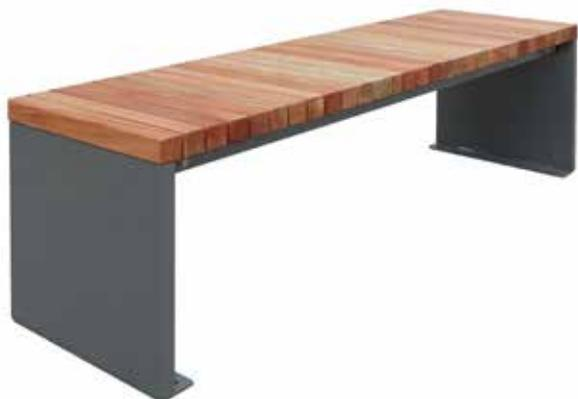
Panchina L. 1800 mm con struttura in acciaio zincato e verniciato, costituita da due supporti in lamiera con piastre base per il fissaggio con tasselli. La seduta è formata da doghe in legno di pino nordico trattato per esterno. A richiesta può essere utilizzato legno di pregio.
