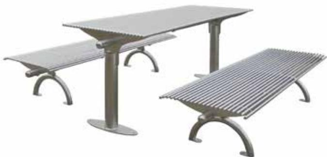
Set L.1970 mm con struttura in acciaio zincato e verniciato, formato da supporti in tubolare che poggiano su una base ellittica forata per il tassellamento al suolo. Il piano del tavolo e delle panchine sono composti da tubolari chiusi alle estremità da tappi. A richiesta può essere realizzato in acciaio inox.
