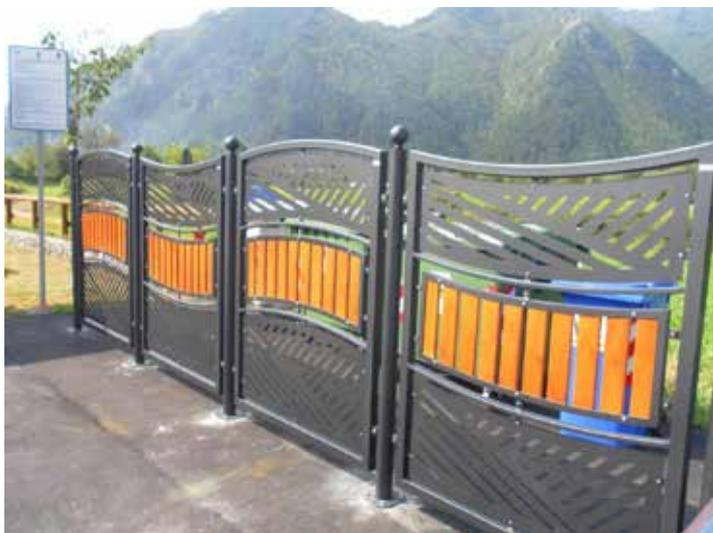
Pannello di schermatura per isola ecologica formato da un telaio in acciaio zincato e verniciato e doghe in legno. Il telaio dei pannelli e della porta è in tubo quadro. Il pannello è costituito da lamiera intagliata al laser con fissate doghe in legno di pino verniciate color ciliegio. I supporti laterali del pannello, da inghisare nel terreno, sono in tubolare con sfera decorativa superiore e piastra decorativa nella parte inferiore.
