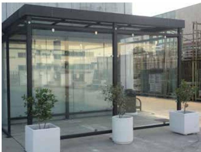
Pensilina per la pausa dei fumatori. Struttura composta da montanti in tubolare collegati tra loro da traversi orizzontali a rinforzo della struttura. Completa di grondaie. La copertura può essere realizzata in lamiera grecata oppure in policarbonato compatto o alveolare. Le pareti laterali possono essere in vetro o in policarbonato compatto. Tutte le parti metalliche sono zincate e verniciate.
