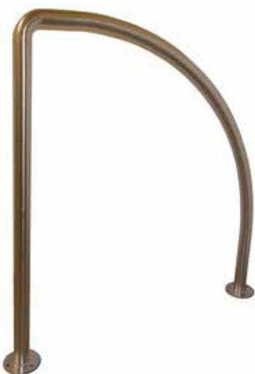
Portabici ad 1-2 posti realizzato mediante piegatura di tubolare in acciaio. Il portabici viene fornito da inghisare con piastre decorative per coprire il foro o su richiesta con piastra di base da tassellare. Può essere fornito zincato e verniciato o nella versione in acciaio inox. Si può installare singolarmente o a batteria.
