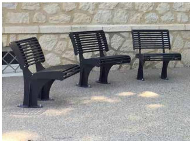
Panchina L.600 mm in acciaio zincato e verniciato o in acciaio inox. Seduta e schienale composti da trafilati in tubolare saldati a sostegni in lamiera sagomati e chiusi da flange di chiusura tagliate con tecnologia laser. I due supporti possono essere predisposti per il fissaggio al suolo con tasselli o da inghisare.
