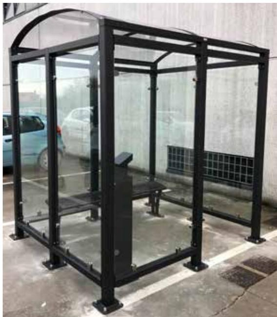
Copertura costituita da colonne portanti in acciaio collegate superiormente da un profilo in lamiera piegata con funzione di pluviale. La copertura e le pareti sono in vetro e policarbonato alveolare. A richiesta possono essere in policarbonato compatto. Struttura in acciaio zincato e verniciato. A richiesta può essere fornita con panchina, bacheca o spegni sigarette.
