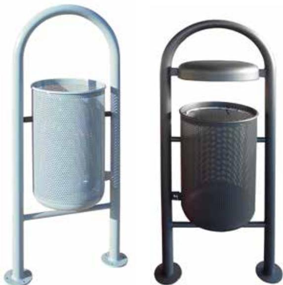
Contenitore a forma cilindrica ottenuto dalla calandratura a freddo di lamiera. La parte superiore viene bordata mentre la parte inferiore viene chiusa con un fondello bombato. Viene fornito completo di anello reggi-sacco. Il sostegno in tubolare è fornito da tassellare o da inghisare. Tutte le parti metalliche sono zincate e verniciate a polveri poliestere termoidurenti. A richiesta si può avere con coperchio con posacenere.
