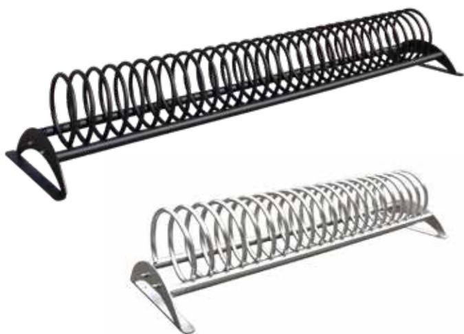
Portabici costituito da un elemento a spirale saldato su due tubolari e fissato all'estremità a due supporti in lamiera ricavati da taglio laser, con fori per il tassellamento al suolo. La struttura è realizzata in acciaio zincato e verniciato. Può essere da 5, 7 e 9 posti, ed inoltre con accostamenti in serie può fare composizione a batteria. Disponibile anche nella versione in acciaio inox.
