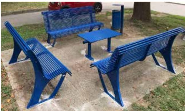
Set L.2070 mm con struttura in acciaio zincato e verniciato. I fianchi delle panchine sono costituiti da due robuste spalle laterali tagliate al laser e ribordate in piatto saldato nella parte posteriore e inferiore. Le sedute ed il piano del tavolo sono composti da tubolari chiusi alle estremità da tappi.
