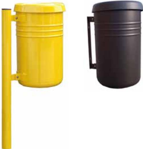
Contenitore a forma cilindrica ottenuto dalla calandratura a freddo di lamiera. La parte superiore viene bordata con un anello mentre la parte inferiore viene chiusa con un fondello bombato. L'anello superiore apribile ha la funzione di reggisacco. Il contenitore è sostenuto da un tubolare in acciaio da inghisare, chiuso nella parte superiore con un tappo in PVC. Tutte le parti metalliche sono zincate e verniciate. Capacità 45 lt.
