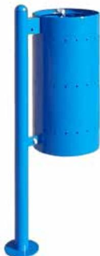
Cestino realizzato in acciaio inox o a richiesta in acciaio zincato e verniciato. Contenitore di forma cilindrica ottenuto dalla calandratura a freddo di lamiera. La parte superiore viene bordata mentre la parte inferiore viene chiusa con un fondello. Viene fornito completo di anello reggi-sacco. Il contenitore è fissaggio ad un sostegno in tubolare per il fissaggio tasselli o da inghisare. Completo di coperchio con posacenere. Capacità 50 lt.
