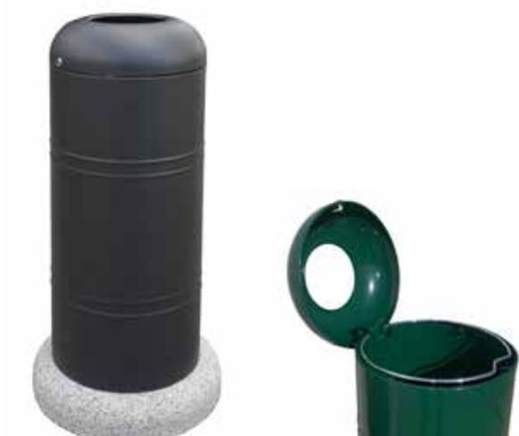
Cestino costituito in lamiera con nervature, con anello di irrigidimento superiore ed inferiore in piatto di acciaio calandrato. Il coperchio è ottenuto per tornitura di lamiera ed è forato al centro per l'introduzione dei rifiuti. Il cestino è fornito completo di anello reggi-sacco. La base di appoggio del cestino può essere in cemento o in metallo. Tutte le parti metalliche sono zincate e verniciate.
