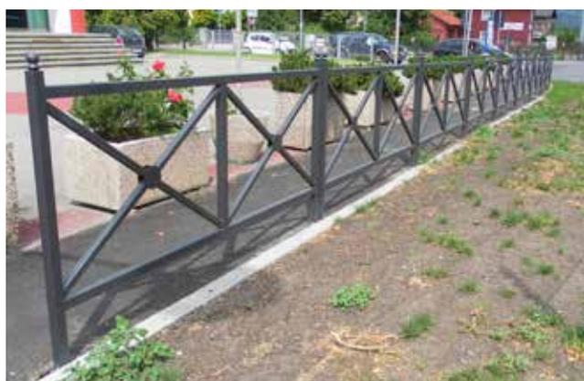
Barriera realizzata da due sostegni in tubolare quadro con sovrastante sfera decorativa. I due traversi orizzontali e il traverso verticale centrale sono in tubolare quadro e le due croci vengono saldate al centro due flange. La barriera può essere fornita da inghisare o da tassellare. Tutte le parti metalliche sono zincate e verniciate.
