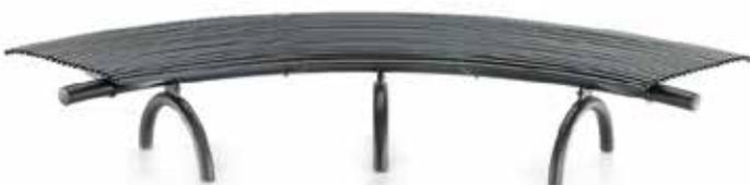
Panchina realizzata in acciaio zincato e verniciato o in inox. È composta da 4 spalle di supporto sagomate in acciaio e collegate tra loro da un traverso orizzontale calandrato (a formare un angolo di 90°) e da una seduta formata da trafilati in tubo calandrati, il tutto è sostenuto da 3 supporti ad arco fissati tramite vite. Il traverso e i trafilati sono chiusi alle estremità.
