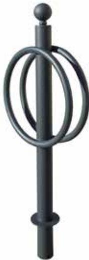
Portabici realizzato in tubolare d'acciaio al quale vengono saldate due "cerchi" in tubo tondo sagomato per assicurare la bicicletta. All'estremità superiore viene saldata una sfera decorativa. Il portabici può essere fornito da inghisare o predisposto con piastra con fori per il fissaggio al suolo tramite tasselli. Le parti metalliche sono zincate e verniciate.
