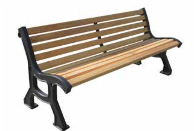
Panchina L.1740 mm o L.2000 mm costituita da due robuste spalle in fusione di ghisa sabbiate e verniciate dotate di alloggiamento per doghe in legno di pregio. La panchina è predisposta per poter essere fissata al suolo con tasselli ad espansione.
