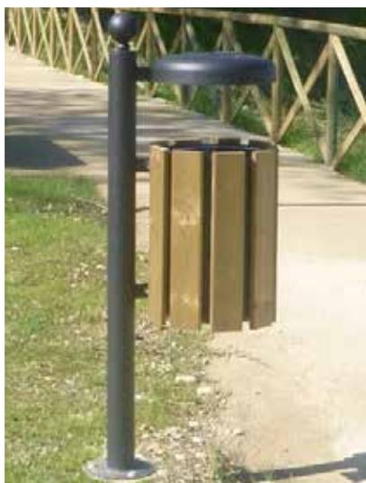
Contenitore ottenuto dalla calandratura a freddo di lamiera. La parte superiore viene bordata con un anello mentre la parte inferiore viene chiusa con un fondello bombato. Rivestito da doghe in legno di pino. L'anello superiore apribile ha la funzione di reggi sacco. Il contenitore è sostenuto da un tubolare completo di coperchio con posacenere. Tutte le parti metalliche sono zincate e verniciate.
