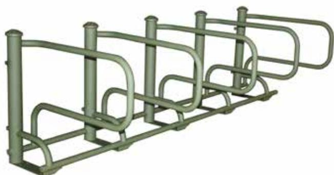
Portabici costituito da elementi reggi-ruota realizzati in tubo opportunamente calandrato e saldato al telaio base in tubolare. Questo portabici è componibile a piacere visto che viene composto assemblando monoblocchi da 1-2 posti insieme ai supporti a "L" in lamiera provvisti di fori per il tassellamento al suolo. Tutte le parti metalliche sono zincate e verniciate. La viteria è in acciaio inox.
