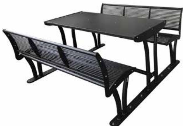
Set L.1615 mm costituito da fianchi laterali in tubolare a sezione sagomata e piastra base per il fissaggio al suolo con tasselli. Seduta e schienale formati da trafilati di acciaio saldati a supporti mentre il piano del tavolo è formato da lamiera opportunamente sagomata. Tutte le parti metalliche sono zincate e verniciate.
