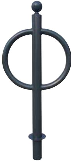
Portabici realizzato in tubolare d'acciaio al quale vengono saldate due "maniglie" in tubo tondo sagomato per assicurare la bicicletta. All'estremità superiore viene saldata una sfera decorativa. Il portabici può essere fornito da inghisare o predisposto con piastra con fori per il fissaggio al suolo tramite tasselli. Le parti metalliche sono zincate e verniciate.
