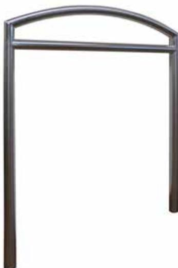
Portabici ad 1-2 posti realizzato mediante piegatura di tubolare in acciaio. Nella parte superiore viene fissato un traverso. Il portabici viene fornito da inghisare o su richiesta con piastra di base da tassellare. Può essere fornito zincato e verniciato o nella versione in acciaio inox. Si può installare singolarmente o a batteria.
