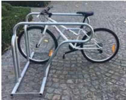
Portabici costituito da elementi reggi-ruota realizzati in tubo opportunamente calandrato e saldato al telaio base. Questo portabici è componibile a piacere visto che viene composto assemblando monoblocchi a 2 posti insieme ai supporti a "L" in lamiera provvisti di fori per il tassellamento al suolo. Tutte le parti metalliche sono zincate e verniciate.
