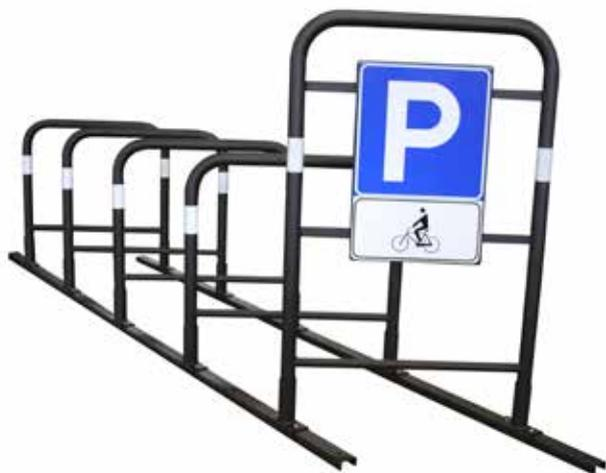
Portabici a batteria realizzato in tubolare fissato alla base ad un profilo a U. A batteria può formare lunghe aree di sosta. Da tassellare al suolo. Ogni arco ha due fasce rifrangenti cl.1. L'arco di inizio è di altezza superiore rispetto agli altri e a richiesta può essere applicata una targa. Zincato e verniciato, può essere collocato dritto o inclinato sino a 45° a seconda dello spazio utile.
