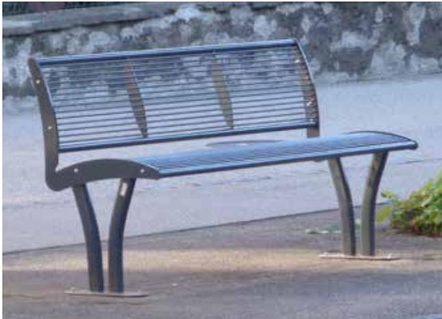
Panchina L.1615 mm costituita da fianchi laterali formati da flange in acciaio con saldate tubolari in acciaio a sezione sagomata e piastra base di forma ovale predisposta per il fissaggio al suolo con tasselli. Seduta e schienale formati da trafilati di acciaio saldati a supporti laterali e supporti centrali sagomati. Tutte le parti metalliche sono zincate e verniciate.
