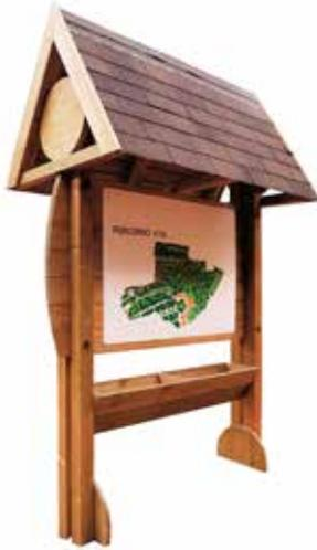
Bacheca con struttura sorretta da due coppie di piantoni, tra i quali sono ammassate le tavole in legno massiccio di pino disegnate alle estremità a creare un profilo curvo. Il tettuccio realizzato con massicci profili è rivestito con perline e tegola canadese rossa. Sotto il pannello espositivo è applicata una fioriera con tavole a sezione trapezoidale.
