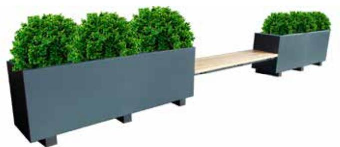
Fioriera costituita da uno scatolato in lamiera tagliato al laser e piegato. Il fondo ha saldato nella parte inferiore tubolari che fungono da piedini ed è dotato di fori per l'eliminazione dell'eccesso d'acqua. La seduta è realizzata da doghe in legno di pino. A richiesta può essere utilizzato legno di pregio. Le parti metalliche sono zincate e verniciate.
