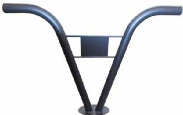
Portabici ad 1-2 posti realizzato da due elementi in tubolare tondo sagomati, chiusi con tappi alle estremità superiori e piastra base provvista di fori per il fissaggio al suolo tramite tasselli ad espansione. L'elemento centrale è composto da due spezzoni in trafilato tondo e porta logo personalizzabile a richiesta su base in lamiera. Tutte le parti sono zincate e verniciate.
