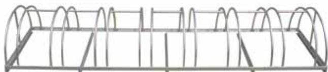
Portabici costituito da una rastrelliera di tondini sagomati e saldati al telaio di base, nella parte inferiore inoltre sono saldati profili a "L" che fungono da sostegni. Può essere fornito nella versione da 4, 5, 6, 8, 10 e 12 posti. Tutte le parti metalliche sono zincate a caldo. Predisposizione per il fissaggio a terra tramite tasselli. A richiesta può essere fornito zincato e verniciato.
