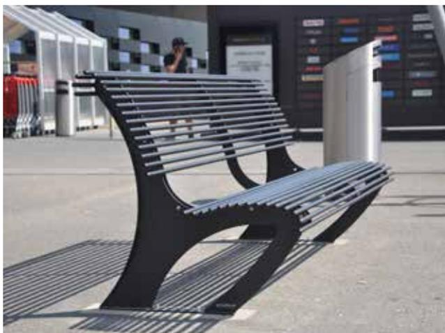
Panchina L.2000 mm costituita da due robuste spalle laterali tagliate al laser e ribordate in piatto saldato nella parte posteriore e inferiore. Seduta e schienale formati da tubolari di acciaio saldati a 3 flange sagomate al laser. I tubolari sono chiusi alle estremità. Le parti metalliche sono zincate e verniciate.
