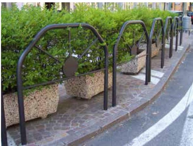
Barriera realizzata mediante la piegatura a freddo di tubo in acciaio con traversi di collegamento in tondo saldati ad un disco centrale utilizzabile come portalogo. Può essere predisposta anche nella versione con pannello porta pubblicitario. Tutte le parti metalliche sono zincate e verniciate. Può essere da inghisare o da tassellare.
