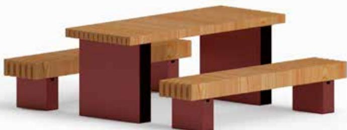
Set L.2000 mm composto da una struttura in tubolare rettangolare. Nella parte superiore dei supporti è fissata la seduta ed il piano del tavolo formati da doghe in legno di pino. La parte inferiore è forata per il fissaggio al suolo. Tutte le parti metalliche sono zincate e verniciate. A richiesta può essere utilizzato legno di pregio.
