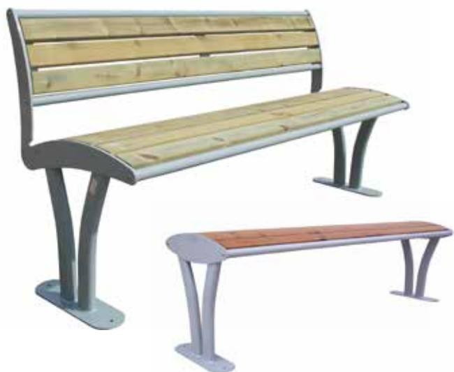
Panchina L.1615 mm costituita da fianchi laterali formati da flange in acciaio con saldati tubolari in acciaio a sezione sagomata e piastra base predisposta per il fissaggio al suolo con tasselli. Seduta e schienale formati da tubolari in acciaio e doghe in legno di pino fissate su supporti in piatto. Le parti metalliche sono zincate e verniciate.
