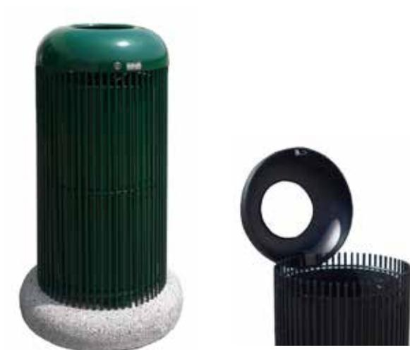
Cestino costituito da tondini saldati a tre anelli di irrigidimento opportunamente calandrati. Il coperchio è ottenuto dalla tornitura in lastra di lamiera ed è forato al centro per l'introduzione dei rifiuti. La base di appoggio del cestino può essere in cemento o in metallo. Il cestino è fornito con contenitore interno ottenuto dalla calandratura di lamiera, forato sul fondo. Tutte le parti metalliche sono zincate e verniciate.
