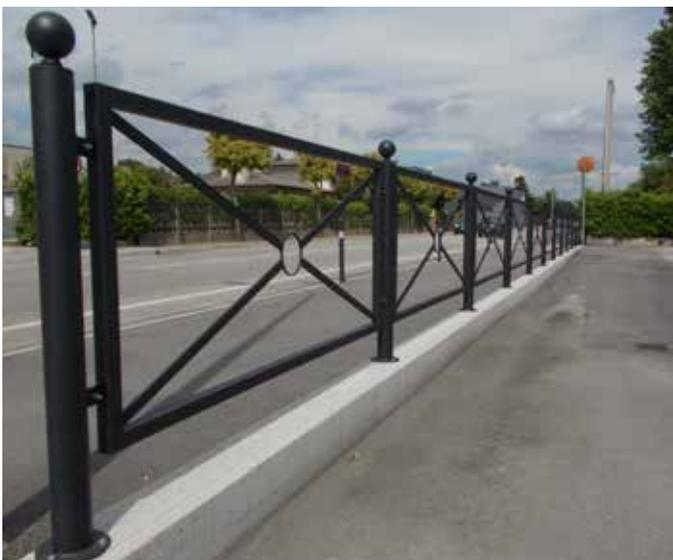
Barriera realizzata da due sostegni in tubolare di acciaio con sovrastante borchia e sfera. Può essere fornita da inghisare o da tassellare al suolo. Pannello realizzato da un telaio perimetrale in tubolare quadro e crociera in piatto con nodo centrale costituito da un anello tondo. La barriera può essere modulare o singola. Le parti metalliche sono zincate e verniciate.
