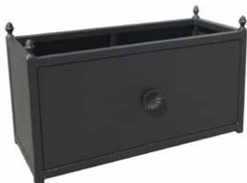
Fioriera composta da una struttura portante in tubolare quadro di acciaio con sovrastanti decori a forma di pigna. Pannellatura realizzata in lamiera con decoro centrale in ferro stampato a forma di fiore. Tutte le parti metalliche sono zincate e verniciate. La fioriera può essere realizzata in diverse misure.
