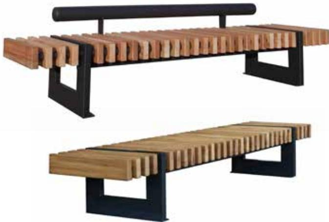
Panchina L.2520 mm con struttura realizzata in tubolare quadro sul quale è saldata una piastra base per il fissaggio al suolo con tasselli. La seduta è realizzata da doghe in legno di pino o di pregio. Lo schienale è costituito da un tubolare. Tutte le parti metalliche sono zincate e verniciate. A richiesta può essere fornita senza schienale.
