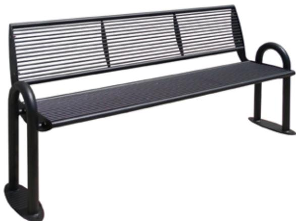
Panchina L.1786 mm costituita da 2 spalle laterali formate da una flangia sagomata al laser e saldata su un arco in tubolare; predisposizione per il fissaggio al suolo con tasselli. Seduta e schienale formati da trafilati di acciaio e tubolari saldati a 2 supporti laterali e 2 supporti centrali. Le parti metalliche sono zincate e verniciate.
