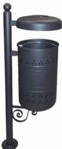
Contenitore ottenuto dalla calandratura a freddo di lamiera. La parte superiore viene bordata con un anello mentre la parte inferiore viene chiusa con un fondello bombato. Completo di anello reggi-sacco. Il contenitore è sostenuto da un tubolare completo di coperchio con posacenere. Tutte le parti metalliche sono zincate e verniciate. Capacità 45 lt
