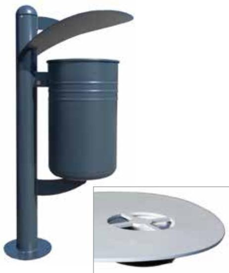
Cestino di forma cilindrica realizzato in acciaio zincato e verniciato. Il contenitore è in lamiera liscia e viene fissato al sostegno in tubolare mediante un aggancio superiore con serratura di tipo universale e uno inferiore con vite e dado. Viene fornito completo di anello reggi sacco, con supporto da inghisare o tassellare. Il coperchio costituito da lamiera tagliata al laser e adeguatamente bombata è saldato alla colonna. Capacità 45 lt.
