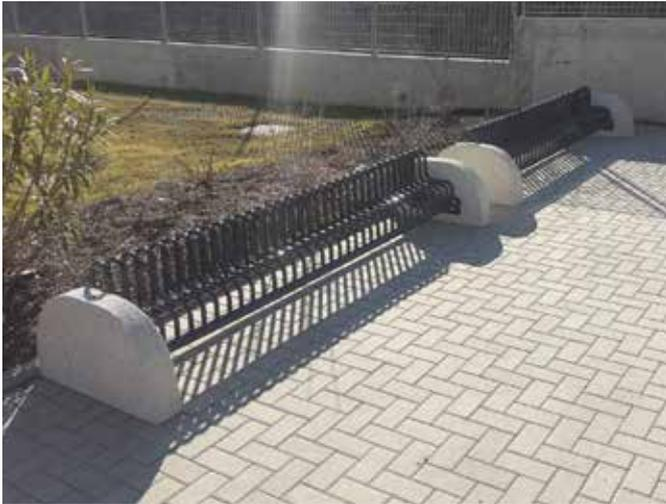
Portabici formato da rastrelliera costituita da elementi in tubolare tondo di acciaio, opportunamente piegati e saldati a due tubolari orizzontali tondi. Alle estremità dei tubolari orizzontali sono saldate le flange in piatto forate per il fissaggio ai muretti laterali di sostegno in calcestruzzo. Tutte le parti metalliche sono zincate e verniciate. Può essere da 3, 5, 7 posti.
