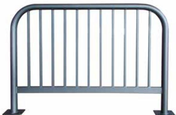
Barriera realizzata da un telaio perimetrale in tubolare tondo, un traverso orizzontale in tubo rettangolare e da tubolari quadri saldati in verticale tra il tubo e il traverso. Tutte le parti sono zincate e verniciate. Può essere inghisata o tassellata al suolo con apposite piastre predisposte di fori per tasselli ad espansione.
