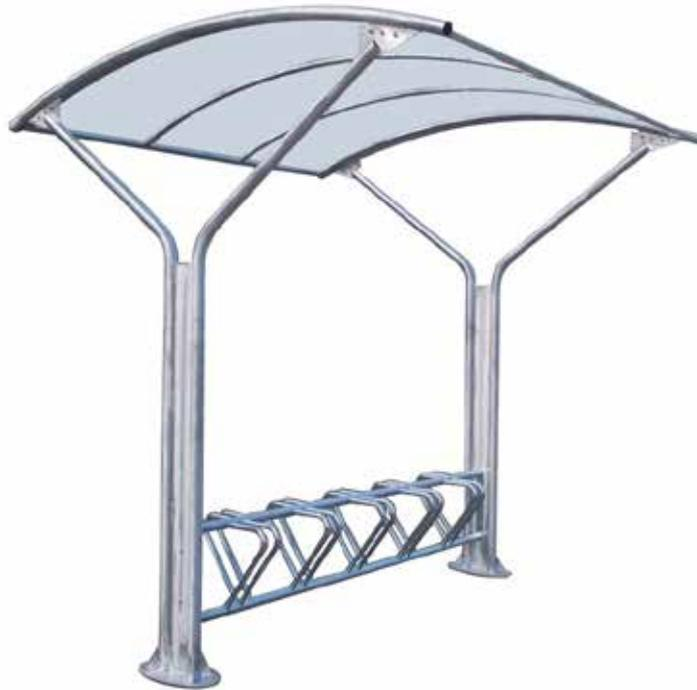
Pensilina per copertura biciclette con montanti in tubolare che possono avere all'estremità una piastra per il tassellamento al suolo o essere allungati per il fissaggio da inghisare. La copertura viene ricavata da tubolare quadro calandrato su cui viene inserito il polycarbonato alveolare. Può essere con o senza grondaia, adatta per essere posizionata a batteria e bifacciale. Struttura zincata e verniciata.
