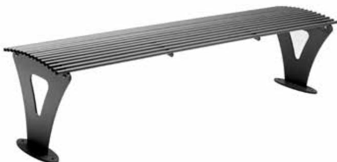
Panchina L.1800 mm costituita da due robuste spalle laterali tagliate al laser, saldate su basi di forma ellittica predisposte per il fissaggio al suolo con tasselli. Seduta composta da tubolari d'acciaio saldati a due supporti laterali e supporti centrali sagomati. Le parti metalliche sono zincate e verniciate.
