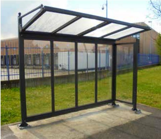
Pensilina in tubolare quadro composta da due montanti di sostegno, inghisati sulla platea, con all'estremità due sfere di decoro. Copertura a sbalzo in tubolare leggermente arcato con grondaia. Viene fornita con parete di fondo costituita da un telaio in estruso di alluminio e polycarbonato alveolare. A richiesta può essere dotata di una o due pareti di lato e può essere realizzata nella versione bifacciale. Tutte le parti metalliche sono zincate e verniciate.
