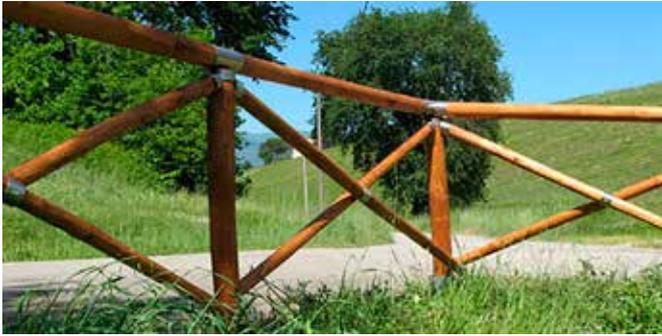
Modulo recinzione a pali tondi e mezzo-tondi torniti, realizzato interamente in castagno impregnato a pressione in autoclave con sali, efficaci contro l'attacco di muffe, funghi e agenti atmosferici. Recinzione costituita da montanti con un traverso orizzontale e due obliqui. Tutte le parti metalliche sono in acciaio inox.
