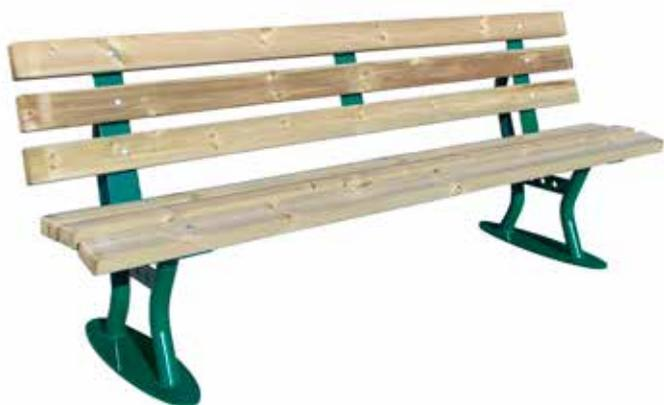
Panchina L.2000 mm con struttura in acciaio zincato e verniciato, formata da gambe sagomate in tubolare che poggiano su una base ellittica con fori per il fissaggio al suolo con tasselli. La panchina può essere realizzata con doghe in pino nordico o interamente in acciaio.
