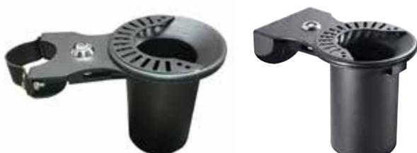
Spegni sigarette in lamiera di acciaio zincato e verniciato. Predisposto per il fissaggio a un tubolare D. 55-60mm tramite apposite staffe a collare come abbinamento a cestini portarifiuti, oppure impiegato singolarmente nella versione con supporto per fissaggio a muro. Il sistema di svuotamento avviene tramite serratura con chiave universale che permette l'estrazione del contenitore dal supporto.
