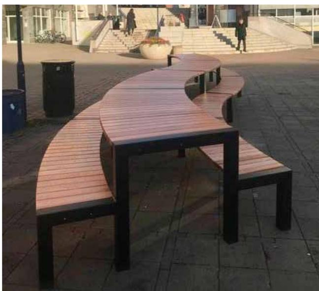
Set composto da una struttura in acciaio zincato e verniciato formata da supporti in tubolare quadro. Ai fianchi vengono saldate piastre con fori per il fissaggio al suolo tramite tasselli. La seduta ed il piano del tavolo sono composti da doghe di legno in pino nordico. A richiesta può essere utilizzato legno di pregio.
