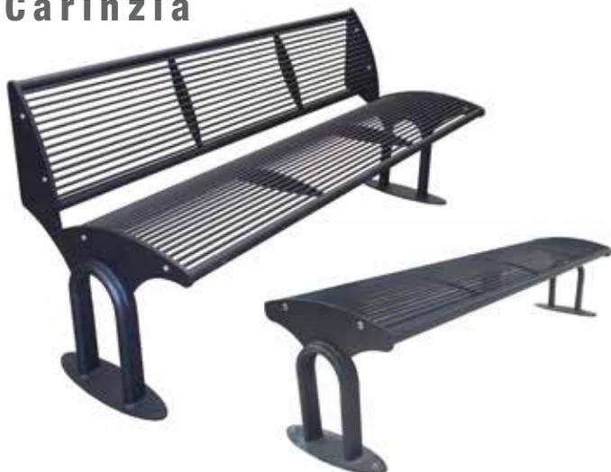
Panchina metallica L. 1786 mm composta da fianchi in tubo d'acciaio di forma ovale, sagomato ad U capovolta, cui vengono saldati i profili di sostegno della seduta e flangia, di forma ovale, per il fissaggio al suolo. Seduta e schienale formati da trafilati di acciaio saldati a supporti laterali e supporti centrali sagomati. Tutte le parti metalliche sono zincate a e verniciate.
