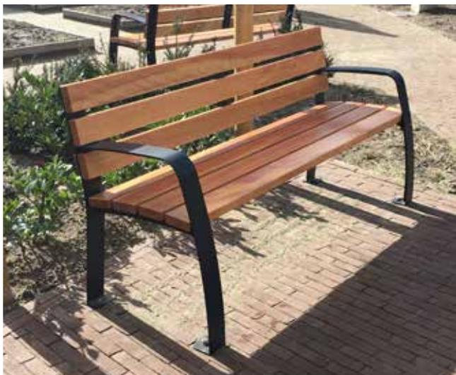
Panchina L.1800 mm con struttura in acciaio zincato e verniciato costituita da due supporti in piatto rinforzati da un profilo tagliato a laser con piastre base per il fissaggio con tasselli. La seduta e lo schienale sono formati da doghe in pino nordico trattato per esterno. A richiesta può essere utilizzato legno di pregio.
