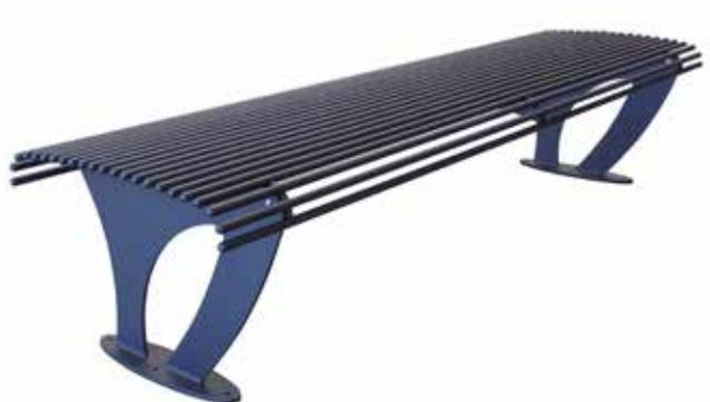
Panchina L. 2000 mm costituita da due robuste spalle laterali tagliate al laser e ribordate in piatto saldato nella parte posteriore ed inferiore. Seduta formata da tubolari d'acciaio saldati a 3 flange sagomate al laser. I tubolari sono chiusi alle estremità. Le parti metalliche sono zincate e verniciate.
