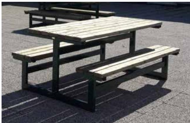
Set L. 2000 mm composto da una struttura in acciaio zincato e verniciato. Ai fianchi vengono saldate delle piastre con fori per il fissaggio al suolo tramite tasselli, la struttura montata diventa corpo unico. Le sedute ed il piano del tavolo sono composti da doghe in legno di pino. Viene realizzato anche il tavolo per le persone in carrozzina.
