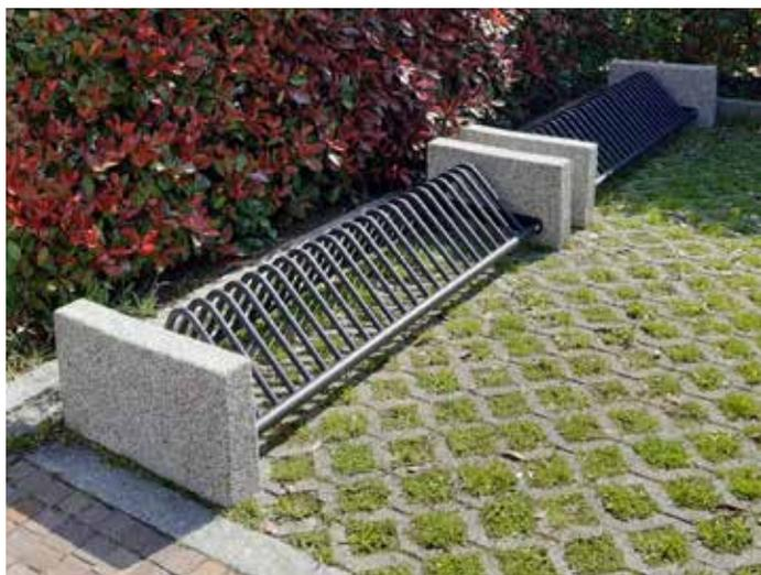
Portabici formato da rastrelliera costituita da elementi in tubolare tondo di acciaio, opportunamente curvati e saldati a due tubolari orizzontali tondi. Alle estremità dei tubolari orizzontali sono saldate le flange in piatto forate per il fissaggio ai muretti laterali di sostegno in calcestruzzo. Tutte le parti metalliche sono zincate e verniciate. Può essere da 5, 7, 9 posti.
