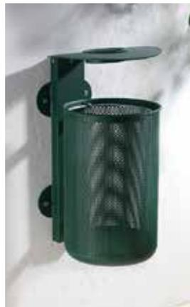
Contenitore ottenuto dalla calandratura a freddo di lamiera. La parte superiore viene bordata con un anello mentre la parte inferiore viene chiusa con un fondello bombato. Viene fornito completo di anello reggi-sacco. Il contenitore è fissato ad un sostegno in tubolare per il fissaggio con tasselli, inghisaggio o a muro. Completo di coperchio ribaltabile con posacenere. Tutte le parti metalliche sono zincate e verniciate. Capacità 45 lt.
