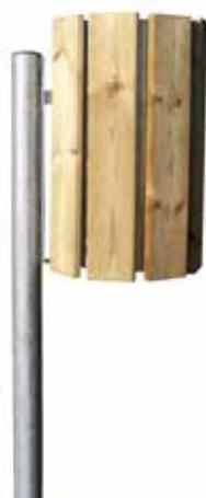
Cestino con contenitore in acciaio zincato di forma cilindrica ottenuto dalla calandratura a freddo di lamiera. Il contenitore viene rivestito in doghe di pino e viene supportato da una staffa d'acciaio che può essere fissata a muro tramite tasselli ad espansione oppure ad un palo da inghisare al suolo e chiuso nella parte superiore con un tappo nero in PVC. Le parti metalliche sono zincate a caldo.
