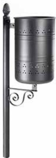
Contenitore a forma cilindrica realizzato in lamiera con nervature e forature estetiche. La parte inferiore viene chiusa con un fondello bombato. Completo di reggi-sacco. Il contenitore è sostenuto da un tubolare in acciaio da inghisare o tassellare, chiuso nella parte superiore da un decoro a forma di pigna. Tutte le parti metalliche sono zincate e verniciate.
