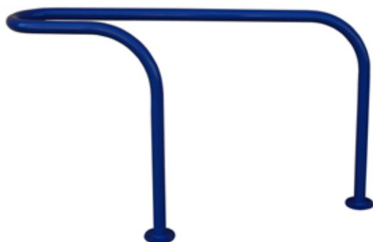
Portabici realizzato mediante piegatura a freddo di tubolare in acciaio. Il portabici viene fornito con piastre forate per il tassellamento al suolo o su richiesta da inghisare con piastre decorative per coprire il foro. Il portabici viene zincato e verniciato. Si può mettere singolarmente o a batteria.
