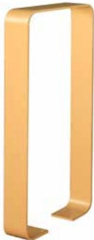
Portabici ad 1-2 posti realizzato in piatto sagomato ad U rovescio adatto per il fissaggio al suolo con tasselli. Le parti metalliche sono zincate e verniciate. Si può installare singolarmente o a batteria.
