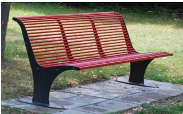
Panchina L.1816 mm costituita da due robuste spalle laterali tagliate al laser, saldate su basi di forma ellittica predisposte per il fissaggio al suolo con tasselli. Seduta e schienale realizzati da tubolari di acciaio, saldati a due supporti laterali e supporti centrali sagomati. Le parti metalliche sono zincate e verniciate.
