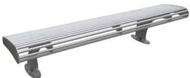
Panchina L. 1800 mm in acciaio zincato e verniciato o in acciaio inox. Seduta composta da trafilati in tubolare saldati a sostegni in lamiera sagomati e chiusi da flange di chiusura tagliate a laser. I due supporti possono essere predisposti per il fissaggio al suolo con tasselli o da inghisare.
