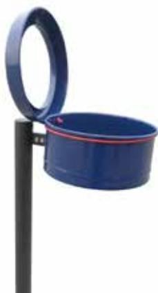
Contenitore a forma cilindrica ottenuto dalla calandratura di lamiera. La parte superiore viene bordata con un anello mentre la parte inferiore viene lasciata aperta. L'anello superiore è apribile e incernierato da un lato ed ha la funzione di reggi-sacco. Supporto in tubolare d'acciaio da inghisare. Può essere fornito singolo o fino a 4 contenitori. Le parti metalliche sono zincate e verniciate.
