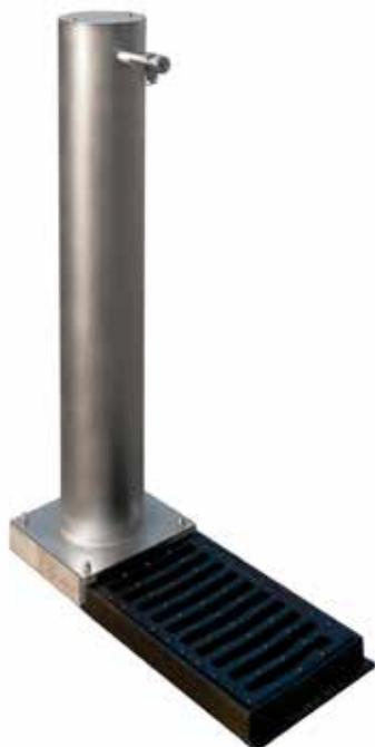
Fontana costituita da una struttura in tubolare d'acciaio inox tondo chiusa nella parte superiore da un tappo in acciaio. Alla base è saldata una piastra quadrata predisposta con fori per il fissaggio tramite tasselli. Tutte le parti in acciaio inox sono con finitura sabbiata elettrolucidata. Il rubinetto in acciaio inox è del tipo a pulsante frontale con molla di ritorno. La caditoia è interamente in ghisa verniciata.
