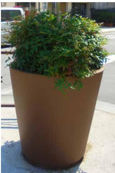
Fioriera realizzata in lamiera tagliata al laser e piegata. La parte superiore è ricavata dalla piega della lamiera e crea una cornice. Il fondo sempre in lamiera ha saldato nella parte inferiore 4 pezzi di tubolare che fungono da piedini. Tutte le parti metalliche sono zincate e verniciate. Dotata di fori di scolo per l'eliminazione dell'eccesso d'acqua. Può essere realizzata in varie dimensioni e con struttura in acciaio inox.
