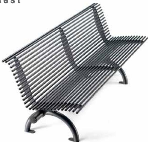
Panchina L.1970 mm composta da trafilati in tubolare di acciaio chiusi alle estremità, saldati a sostegni in lamiera sagomati al laser, saldati a un traverso orizzontale in tubolare chiuso alle estremità. I supporti in tubolare sagomati ad arco e fissati al traverso centrale sono forniti di piastrina predisposta per il fissaggio al suolo. Le parti metalliche sono zincate e verniciate.
