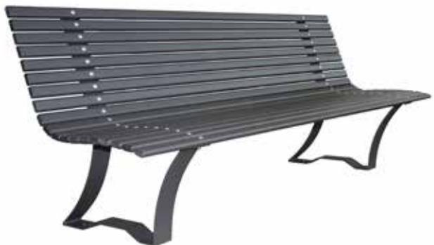
Panchina L.1995 mm con struttura in acciaio zincato e verniciato costituita da due supporti in piatto opportunamente sagomati e forati per il fissaggio al suolo con tasselli. La seduta e lo schienale sono composti da tubi ovali chiusi alle estremità da tappi in PVC e fissati ai fianchi tramite viti.
