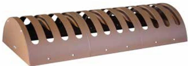
Portabici formato da elementi fissati tra di loro. Ogni elemento è costituito da una lamiera tagliata a laser con 4 fori per l'alloggiamento delle bici, opportunamente calandrata, e dei rinforzi in lamiera con la predisposizione di fori per il fissaggio dei componenti fra loro. Gli elementi vengono poi fissati ad un profilo ad "L" forato in modo tale da permettere il tassellamento al suolo. Il portabici è interamente zincato e verniciato. Tutta la viteria è in acciaio inox.
