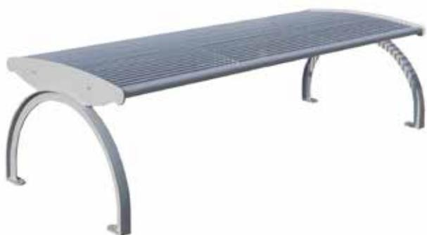
Panchina L. 1675 mm costituita da 2 spalle laterali formate da una flangia sagomata al laser e saldata su un arco in piatto; predisposta per il fissaggio al suolo con tasselli. Seduta formata da trafilati di acciaio e tubolari saldati a 2 supporti laterali e 2 supporti centrali. Le parti metalliche sono zincate e verniciate. Può essere fornita in acciaio inox.
