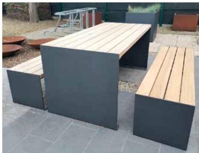
Set L.1800 mm composto da una struttura in acciaio zincato e verniciato formato da gambe tagliate al laser con saldate alla base una piastra con fori per il fissaggio al suolo con tasselli e sulla parte superiore un piatto sul quale vengono fissate le doghe di legno in pino. A richiesta può essere utilizzato legno di pregio.
