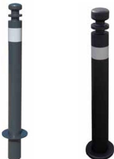
Dissuasore realizzato in tubolare di acciaio zincato e verniciato. Il fissaggio al suolo avviene con piastra a base tonda provvista di fori per il tassellamento, oppure con prolungamento per essere inghisato direttamente al suolo. A richiesta può essere applicata la fascia rifrangente.
