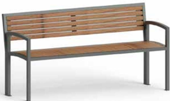
Panchina L.1560 mm con struttura portante e braccioli in tubolare di acciaio zincato e verniciato. La seduta e lo schienale sono formate da doghe in legno di pino nordico trattato. A richiesta può essere utilizzato legno di pregio. Per dare stabilità alla seduta ed allo schienale, centralmente viene fissato tramite viti un rinforzo.
