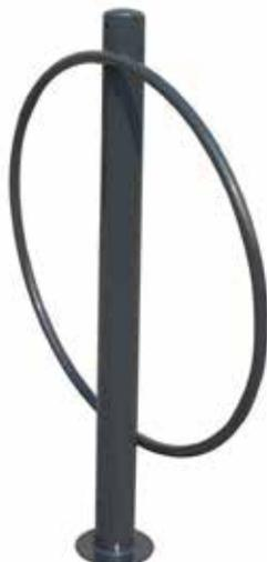
Portabici realizzato in tubolare d'acciaio al quale viene saldato un "cerchio" in tubo tondo sagomato per assicurare la bicicletta. Il portabici può essere fornito da inghisare o predisposto con piastra con fori per il fissaggio al suolo tramite tasselli. Le parti metalliche sono zincate e verniciate.
