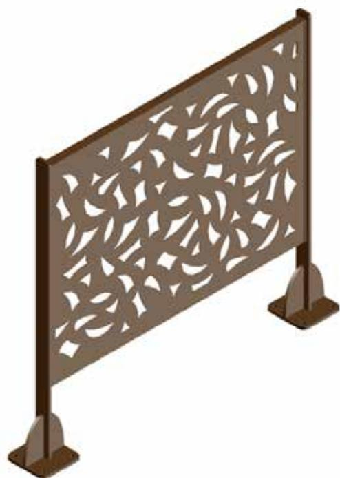
Barriera realizzata da due sostegni in piatto. Può essere fornita da inghisare o da tassellare al suolo. Pannello realizzato da un telaio perimetrale in tubolare quadro e lamiera tagliata al laser. La barriera può essere modulare o singola. Le parti metalliche sono zincate e verniciate. È possibile realizzare un design diverso della lamiera con forme a piacere.
