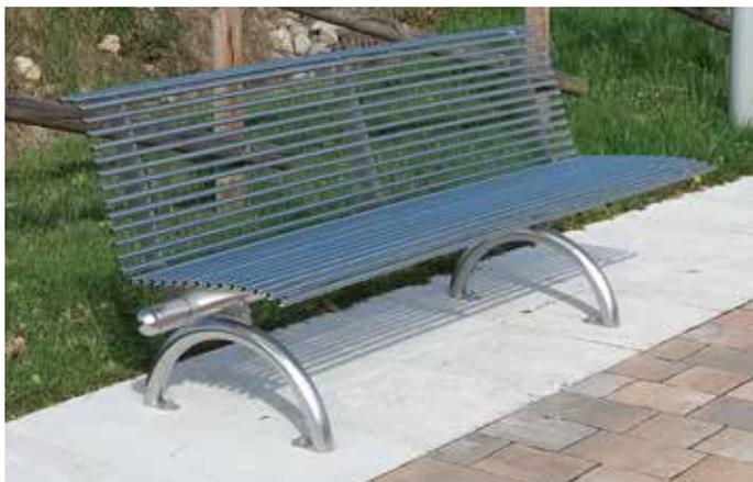
Panchina L.1970 mm composta da trafilati in tubolare inox chiusi alle estremità, saldati a sostegni in lamiera inox sagomati al laser, saldati a un traverso orizzontale in tubolare chiuso alle estremità. I supporti in tubolare sagomati ad arco e fissati al traverso centrale sono forniti di piastrina predisposta per il fissaggio al suolo. La panchina viene sottoposta a vari trattamenti per rendere la superficie brillante.
