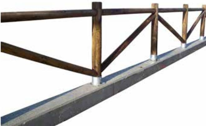
Modulo recinzione realizzato interamente in pino nordico impregnato a pressione in autoclave con sali in conformità alle norme DIN 68800, efficaci contro l'attacco di muffe, funghi e agenti atmosferici. Recinzione costituita da montanti in tubolare con un traverso orizzontale ed uno obliquo.
