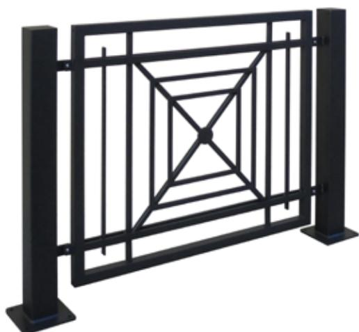
Barriera realizzata da due sostegni in tubolare e pannellatura con fantasia interna creata saldando tra loro piatti in acciaio e tubolari quadri in acciaio finendo con una flangia al centro. Tutte le parti metalliche sono zincate e verniciate. Può essere sia da inghisare che da tassellare.
