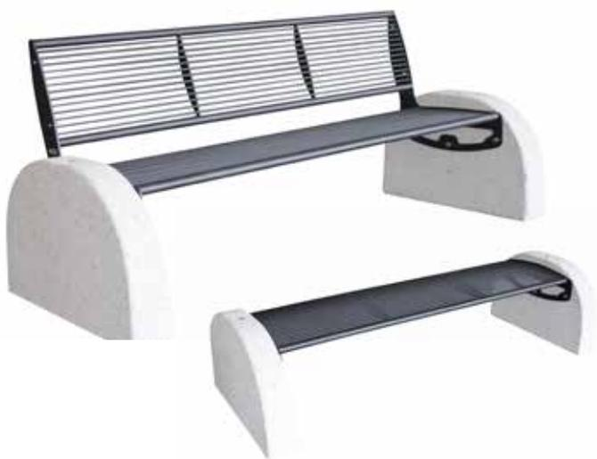
Panchina L. 1900 mm costituita da fianchi laterali in cemento. Seduta e schienale sono formati da trafilati di acciaio saldati a supporti laterali e centrali sagomati. I supporti laterali sono fissati ai fianchi in acciaio opportunamente forati per il fissaggio ai cementi. Tutte le parti metalliche sono zincate e verniciate.
