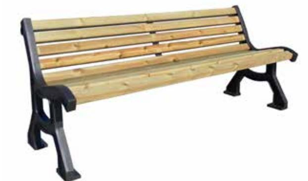
Panchina L.1740 mm o L.2000 mm costituita da due robuste spalle in fusione di ghisa sabbiate e verniciate dotate di alloggiamento per doghe in legno di pino nordico. La panchina è predisposta per poter essere fissata al suolo con tasselli ad espansione.
