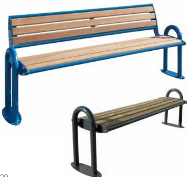
Panchina L.1786 mm costituita da due spalle laterali formate da una flangia in acciaio sagomata al laser e saldata su un arco in tubolare. Predisposizione per il fissaggio al suolo con tasselli. Seduta e schienale formati da due tubolari in acciaio e doghe in legno di pino fissate su tre supporti in piatto. Le parti metalliche sono zincate e verniciate.
