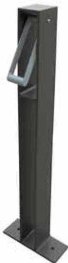
Portabici realizzato con piatti opportunamente piegati e saldati tra loro, ad una distanza sufficiente da poter inserire la ruota anteriore della bici. Il prodotto è provvisto di fori per il tassellamento alla base, e di maniglia estraibile per agganciare la bici con il lucchetto. Tutte le parti in acciaio sono zincate e verniciate.
