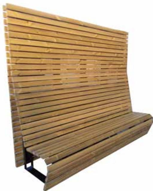
Panchina L. 2520 mm con struttura in acciaio zincato e verniciato, formata da cinque supporti provvisti di base forata per il tassellamento al suolo. La panchina è composta da 3 pezzi: panchina, parete posteriore e parete anteriore/superiore. Le doghe sono in legno di pino trattate in autoclave. A richiesta può essere usato legno di pregio.
