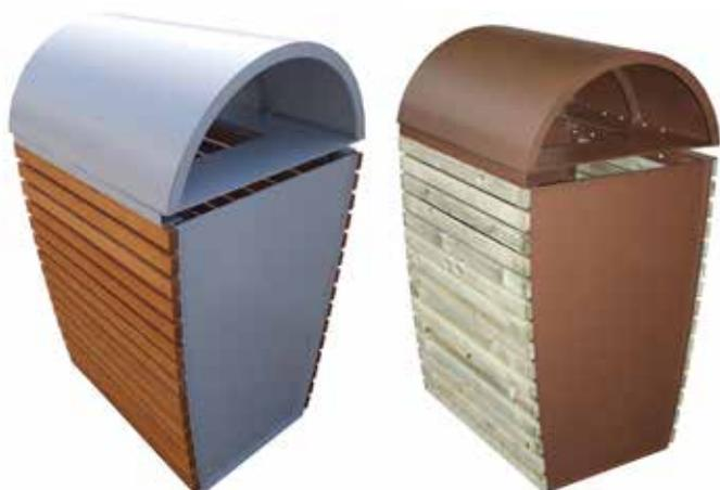
Cestone costituito interamente in lamiera zincata e verniciata. L'introduzione dei rifiuti avviene attraverso il foro, sotto il coperchio di forma cilindrica apribile, fissato al fusto tramite cerniera. Il cestone è dotato di contenitore interno. La base di appoggio del cestino è provvista di fori per il fissaggio al suolo tramite tasselli. Su due lati il cestone è ricoperto di doghe in legno di pino. A richiesta può essere usato legno di pregio. Capacità 120 lt.
