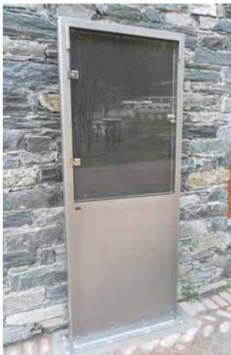
Totem in lamiera d'acciaio inox o zincata e verniciata. Fissaggio al suolo tramite zoccolo in acciaio inox con predisposizione per il tassellamento al suolo. La superficie espositiva è protetta da vetro temperato. Completo di gocciolatoio. Pannello di fondo in lamiera zincata e verniciata. A richiesta può essere monofacciale o bifacciale.
