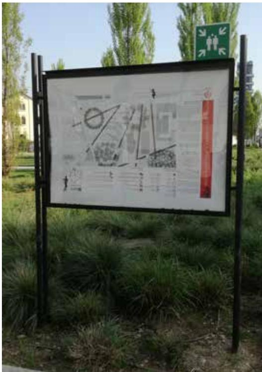
Bacheca composta da due supporti in acciaio realizzati con tubolari collegati tra loro tramite piastrelle saldate. Il telaio della bacheca è formato da uno scatolato in lamiera con anta apribile in profilo di alluminio estruso e vetro antisfondamento stratificato con serratura. Il pannello espositivo può essere monofacciale o bifacciale. Tutte le parti metalliche sono zincate e verniciate.
