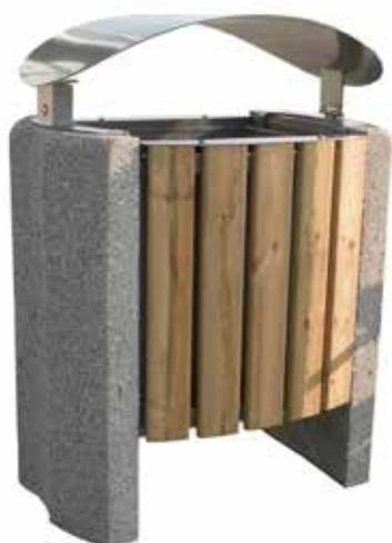
Cestino costituito da una struttura metallica fissata tramite viti ai due fianchi in cemento. Il contenitore è ricoperto da doghe in legno di pino trattato. Il contenitore interno in lamiera zincata e verniciata è provvisto di maniglie laterali per l'estrazione. Su richiesta può essere fornito con coperchio. Le parti metalliche sono in acciaio zincato e verniciato. Capacità 80 lt.
