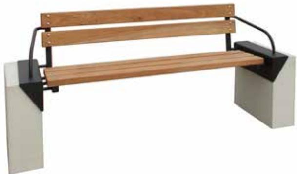
Panchina L.2076 mm formata da due supporti laterali in tubolare di acciaio, seduta e schienale in legno di pino impregnato in autoclave e fianchi laterali in conglomerato cementizio. La panchina è provvista di braccioli laterali in tubo tondo di acciaio sagomato. Le parti metalliche sono zincate e verniciate.
