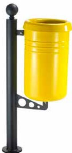
Contenitore a forma cilindrica ottenuto dalla calandratura a freddo di lamiera. La parte superiore viene bordata con un anello mentre la parte inferiore viene chiusa con un fondello bombato. L'anello superiore apribile ha la funzione di reggi-sacco. Il contenitore è sostenuto da un tubolare in acciaio da inghisare o da tassellare. Tutte le parti metalliche sono zincate e verniciate.
