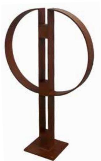
Portabici realizzato in piatto d'acciaio al quale vengono saldate due "maniglie" in piatto sagomato per assicurare la bicicletta. Il portabici può essere fornito da inghisare o con piastra con fori per il fissaggio al suolo tramite tasselli. Le parti metalliche sono zincate e verniciate.
