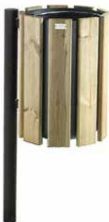
Cestino con contenitore in acciaio di forma cilindrica ottenuto dalla calandratura a freddo di lamiera. Il contenitore viene rivestito in doghe di pino e viene fissato ad un palo da inghisare al suolo e chiuso nella parte superiore con un tappo nero in PVC. Completo di anello reggi sacco. Le parti metalliche sono zincate e verniciate.
