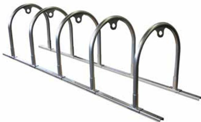
Portabici realizzato in tubolare sagomato ad arco fissato alla base ad un profilo a U. L'elemento centrale è realizzato in lamiera tagliata al laser per poter assicurare la bicicletta sul telaio. A batteria può formare lunghe aree di sosta. Da tassellare al suolo. Le parti metalliche sono in acciaio inox o in acciaio zincato e verniciato.
