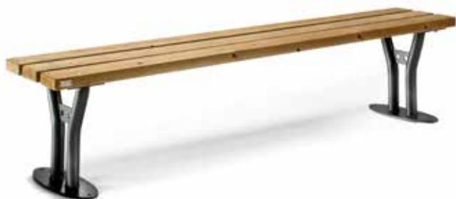
Panchina L.2000 mm con struttura in acciaio zincato e verniciato, formata da gambe sagomate in tubolare che poggiano su una base ellittica con fori per il fissaggio al suolo con tasselli. La panchina può essere realizzata con doghe in pino nordico o interamente in acciaio.
