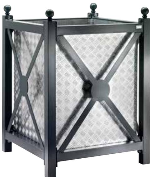
Fioriera composta da una struttura portante in tubolare quadro di acciaio con sovrastanti borchie e sfere decorative. Pannellatura realizzata da telaio perimetrale in tubolare quadro e crociera in piatto con nodo centrale in tondo pieno. La vasca interna è realizzata in lamiera di alluminio mandorlata con elementi in angolare d'acciaio come rinforzi interni. Tutte le parti metalliche sono zincate e verniciate.
