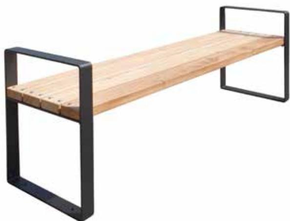
Panchina L.1800 mm con supporti piegati e contornati a formare un rettangolo. Sulla base dei supporti ci sono dei fori per il tassellamento al suolo. Seduta formata da doghe in legno di pino. A richiesta può essere utilizzato legno di pregio. La struttura può essere fornita in acciaio zincato e verniciato o in acciaio inox.
