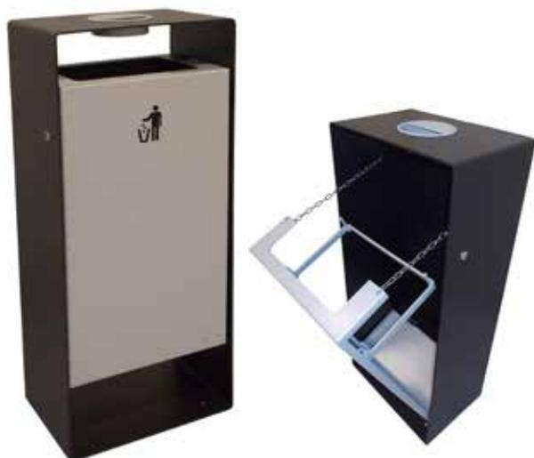
Cestino di forma rettangolare costituito interamente in lamiera zincata e verniciata. Nella parte inferiore il cestino è dotato di fori per il fissaggio al suolo con tasselli. Il coperchio superiore è dotato del posacenere estraibile. L'apertura del cestino avviene tramite una porta frontale dotata di serratura con chiave universale e catena antiribaltamento.
