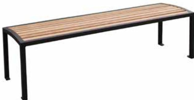
Panchina L. 1560 mm con struttura portante in tubolare di acciaio zincato e verniciato. La seduta è formata da doghe in legno di pino nordico trattato. Su richiesta può essere utilizzato legno di pregio. Per dare stabilità alla seduta, centralmente viene fissato tramite viti un rinforzo.
