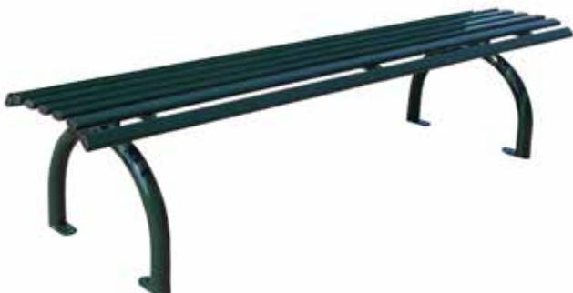
Panchina L.2000 mm realizzata interamente in acciaio zincato e verniciato. La seduta è composta da tubi ovali chiusi alle estremità da tappi in PVC, saldati a tre sostegni in lamiera sagomati con tecnologia laser. I due supporti in tubolare sono sagomati ad arco e fissati al traverso centrale tramite viti, sono forniti di piastrina per fissaggio al suolo.
