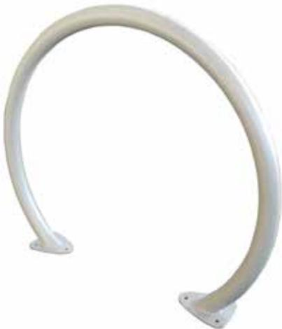
Portabici ad 1-2 posti realizzato mediante calandratura di tubolare in acciaio. Il portabici viene fornito con piastra di base per il tassellamento al suolo o su richiesta da inghisare con piastre decorative per coprire il foro. Può essere fornito in acciaio zincato e verniciato o in acciaio inox. Si può installare singolarmente o a batteria.
