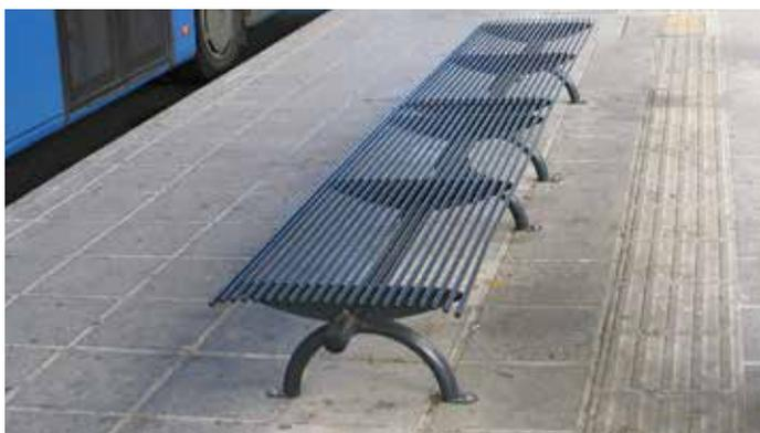
Panchina L.1970 mm realizzata in acciaio zincato e verniciato o in inox. La seduta è composta da trafilati in tubolare chiusi alle estremità, saldati a sostegni in lamiera sagomati al laser. I due supporti in tubolare sagomati ad arco sono fissati al traverso centrale tramite viti.
