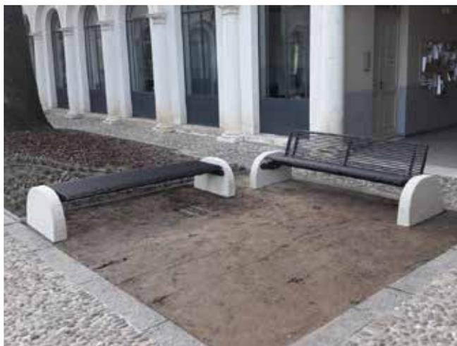
Panchina L. 2340 mm con due supporti laterali in cemento. Seduta e schienale formati da tubolari di acciaio chiusi alle estremità da un piatto e saldati su 3 supporti tagliati al laser saldati su un tubolare orizzontale. Le parti metalliche sono zincate e verniciate.
