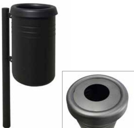
Contenitore a forma cilindrica ottenuto dalla calandratura a freddo di lamiera. La parte superiore viene bordata con un anello mentre la parte inferiore viene chiusa con un fondello bombato. L'anello superiore apribile ha la funzione di reggi-sacco ed ha saldato una riduzione. Il contenitore è sostenuto da un tubolare in acciaio da inghisare, chiuso nella parte superiore con un tappo in PVC. Tutte le parti metalliche sono zincate e verniciate.
