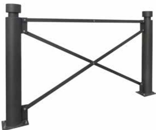
La barriera è realizzata con due montanti in tubolare di acciaio e pannello ricavato piegando il piatto con intreccio a "x" saldato in centro e alle estremità viene fissato sul montante. Può essere di varie dimensioni e anche nella versione a composizione in continuità. Il fissaggio al suolo avviene tramite tasselli. Tutte le parti in acciaio sono zincate e verniciate.
