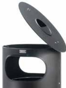
Cestino costituito in lamiera, con anello di irrigidimento superiore ed inferiore in piatto di acciaio calandrato. Il fusto del cestino è forato lateralmente per l'introduzione dei rifiuti. Il coperchio apribile è in lamiera ed è completo di posacenere. Il cestino è fornito completo di contenitore interno. La base di appoggio del cestino può essere in cemento o in metallo. Tutte le parti metalliche sono zincate e verniciate.
