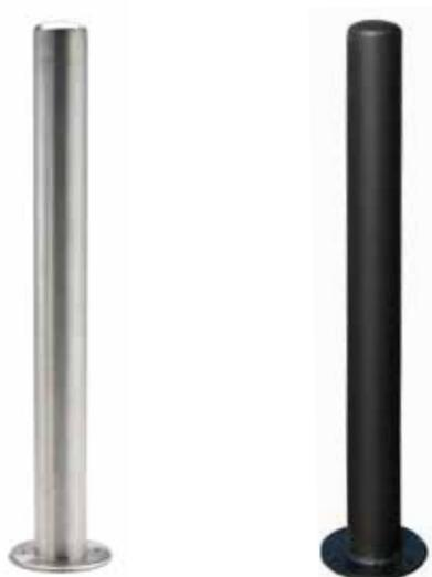
Dissuasore realizzato in tubolare d'acciaio con chiusura superiore con calotta. Il fissaggio al suolo è previsto con piastra base per il fissaggio tramite tasselli, oppure con prolungamento per essere inghisato. Il dissuasore può essere in acciaio inox o in acciaio zincato e verniciato.
