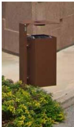
Contenitore a forma quadra, ottenuto dalla calandratura a freddo di lamiera. La parte inferiore è chiusa e forata al centro. Viene fornito completo di anello reggi-sacco. Il contenitore è fissato a un sostegno in tubolare per il fissaggio con tasselli, inghisaggio o a muro. Completo di coperchio con posacenere. Tutte le parti metalliche sono zincate e verniciate. Capacità 55 lt.
