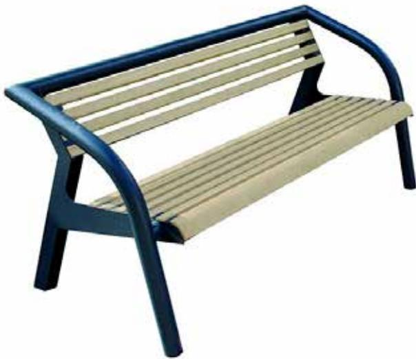
Panchina L.1870 mm costituita da due spalle laterali in acciaio sagomate con tecnologia laser. La struttura dello schienale e i sostegni laterali sono realizzati in tubolare di acciaio. La seduta e lo schienale sono composti da doghe in legno di pino nordico trattato. Le piastre base sui sostegni laterali sono predisposte di foro per il fissaggio al suolo tramite tasselli. Tutte le parti metalliche sono zincate e verniciate.
