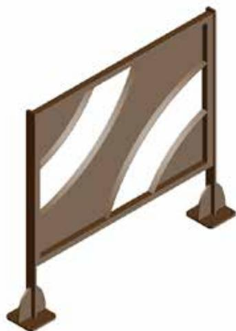
Barriera realizzata da due sostegni in piatto. Può essere fornita da inghisare o da tassellare al suolo. Pannello realizzato da un telaio perimetrale in tubolare quadro, piatti opportunamente sagomati ad arco e delle lamiere tagliate al laser. La barriera può essere modulare o singola. Le parti metalliche sono zincate e verniciate.
