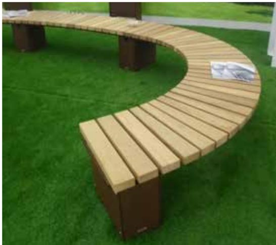
Panchina realizzata con struttura in tubolare rettangolare. Nella parte superiore dei supporti è fissata la seduta formata da doghe in pino nordico. A richiesta può essere usato legno di pregio. La parte inferiore è forata per il fissaggio al suolo. Tutte le parti metalliche sono zincate e verniciate.
