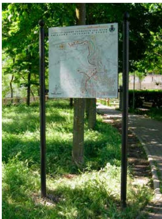
Bachecca composta da due 2 colonne portanti in tubolare d'acciaio con sfera decorativa di testa. Il telaio centrale è costituito da un tubolare in ferro a sezione quadra al quale viene rivettata una lamiera di alluminio che servirà da base per l'affissione di manifesti. Il pannello può avere varie dimensioni. Le parti metalliche sono zincate e verniciate.
