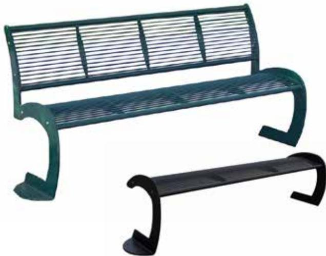
Panchina in metallo L. 1861 mm costituita da due robuste spalle laterali in acciaio tagliate a laser e piegate nella parte inferiore a formare le basi di forma semicircolare predisposte per poter fissare la panchina al suolo con tasselli. Seduta e schienale formati da trafilati di acciaio saldati a supporti laterali e supporti centrali sagomati. Le parti metalliche sono zincate e verniciate.
