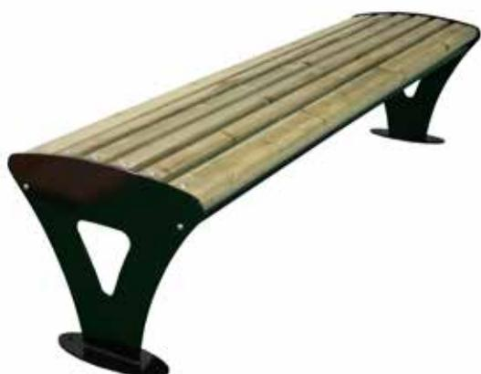
Panchina L.1800 mm costituita da due robuste spalle laterali in acciaio tagliate al laser e saldate su basi di forma ellittica predisposte per poter fissare la panchina al suolo con tasselli. Seduta formata da doghe in pino nordico fissate su tre supporti in piatto. La seduta è fissata alle spalle tramite viti in inox. Le parti metalliche sono zincate e verniciate.
