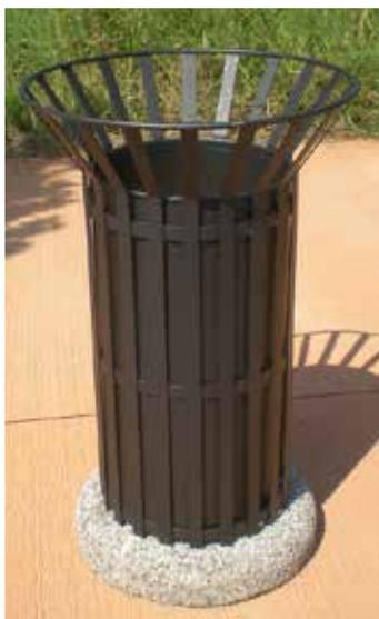
Cestino costituito da raggi in piatto di acciaio opportunamente piegati e uniti con saldatura. La base può essere in cemento o in metallo. Il cestino è fornito con contenitore interno ottenuto dalla calandratura di lamiera. La parte inferiore viene chiusa con un fondello forato per l'eventuale scolo di acqua meteorica o di periodica pulizia. Tutte le parti metalliche sono zincate e verniciate. Capacità 63 lt.
