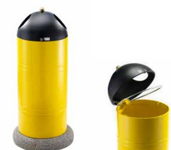
Cestino costituito in lamiera con nervature, con anello di irrigidimento superiore ed inferiore in piatto di acciaio calandrato. Il coperchio è ottenuto per tornitura di lamiera e viene forato lateralmente per l'introduzione dei rifiuti. Sul top del coperchio è fissata una sfera. Il cestino è fornito completo di anello reggi-sacco. La base di appoggio del cestino può essere in cemento o in metallo. Tutte le parti metalliche sono zincate e verniciate.
