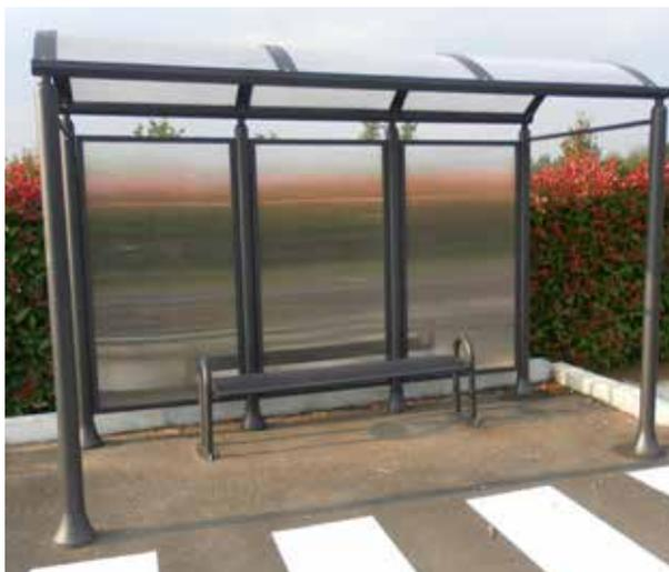
Pensilina costituita da colonne portanti in acciaio e grondaie che fungono anche da traversi orizzontali. La copertura in lastre di polycarbonato alveolare è sostenuta da centine e contro centine. La pareti possono essere in polycarbonato alveolare o in lamiera forata. La pensilina può essere fornita completa di parete laterale, timpano, maniglione in acciaio inox, panca e bacheca informativa. Le parti metalliche sono in acciaio zincato e verniciato.
