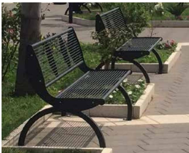
Panchina L.1675 mm costituita da 2 spalle laterali formate da una flangia sagomata al laser e saldata su un arco in piatto; predisposta per il fissaggio al suolo con tasselli. Seduta e schienale formati da trafilati di acciaio e tubolari saldati a 2 supporti laterali e 2 supporti centrali. Le parti metalliche sono zincate e verniciate.
