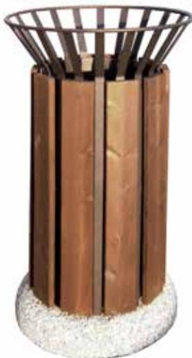
Cestino costituito da raggi in piatto di acciaio opportunamente piegati e uniti con saldatura. La base può essere in cemento o in metallo. Il cestino è ricoperto da doghe in legno di pino trattato ed è fornito con contenitore interno ottenuto dalla calandratura di lamiera. La parte inferiore viene chiusa con un fondello forato per l'eventuale scolo di acqua meteorica o di periodica pulizia. Tutte le parti metalliche sono zincate e verniciate.
