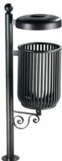
Cestino composto da un contenitore formato da tubi paralleli verticali e anelli calandrati disposti in orizzontale alle due estremità con fondo in lamiera bombata. Viene fornito completo di anello reggi-sacco. Il palo di sostegno è formato da un tubo tondo che può essere fornito da inghisare o da tassellare con piastra base. È dotato di coperchio con posacenere. Tutte le parti metalliche sono zincate e verniciate. Capacità 35 lt
