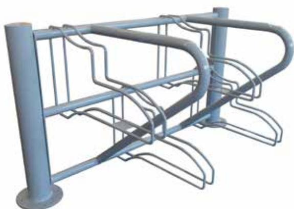
Portabici costituito da elementi reggi-ruota alternati alto-basso realizzati in tondino. Ad ogni di essi è affiancato un archetto che ha la funzione di fissare le bici direttamente al telaio. Le estremità del portabici sono fissate a due colonne in tubolare con saldata alla base una piastra tonda predisposta di fori per il fissaggio al suolo tramite tasselli. Tutte le parti metalliche sono zincate e verniciate. Può essere fornito nella versione da 4 o da 6 posti.
