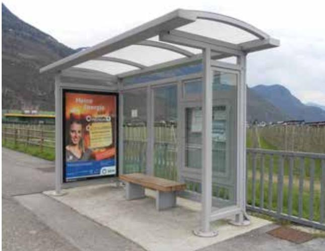
Pensilina caratterizzata da moduli lineari e semplici da assemblare, in tubolare con grondaie in lamiera. La copertura è in policarbonato mentre i tamponamenti sono in vetro stratificato con nei bordi un telaio in estruso di alluminio. Su un lato può essere collocata una bacheca porta pubblicità mono o bifacciale e sulla parete di fondo una bacheca porta info ed orari. Tutte le parti metalliche sono zincate e verniciate a polveri poliestere termoindurenti.
