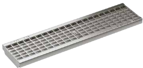
Nätgaller, stål förzinkat, rostfri Belastningsklasser: B125, C250, D400 , Längd: 50 cm, 100 cm MW 30 x 14 mm / 30 x 10 mm / 20 x 14 mm
