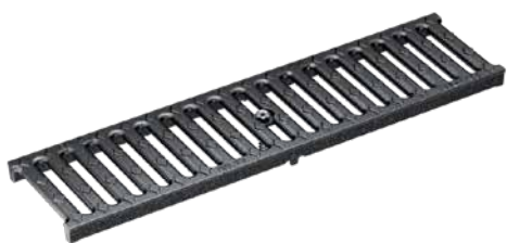
Galler SW 10, gjutjärn, KTL behandlad Belastningsklass: C250 , Längd: 50 cm, SW 10 mm
