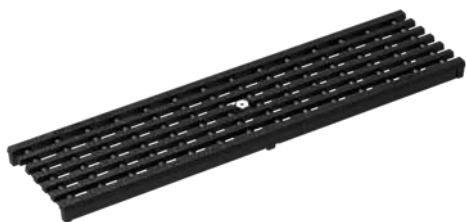
Längsgående galler, gjutjärn, KTL behandlad Belastningsklass: D400* , Längd: 50 cm, MW 25 x 10 mm
