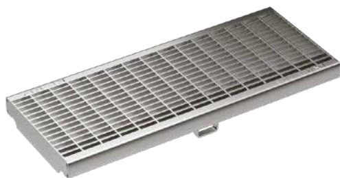
Nätgaller, stål förzinkat, rostfri Belastningsklasser: C250, D400* Längd: 50 cm, 100 cm, MW 30 x 10 mm / 20 x 20 mm
