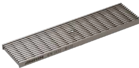
Längsgående galler, rostfri Belastningsklasser: B125, D400 , Längd: 50 cm, 100 cm, SW 5 mm
