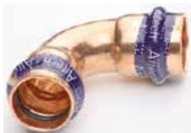
Koppar/rödgods För tappvatten och värme samt oljefri tryckluft. O-ring: EPDM (svart)
