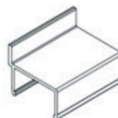
Anslagsprofil gångjärnssida Längd: 2012 mm Art.nr: AP777004
