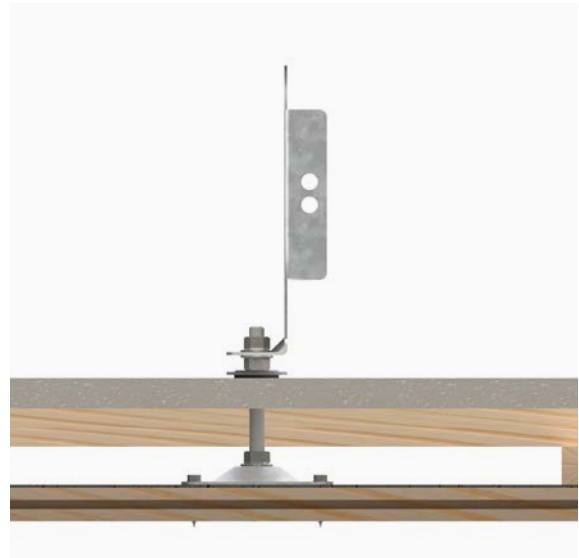
Borrade hål i släta betongpannor.
