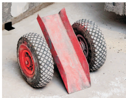
En lätt transportkärra underlättar flyttning av elementen i trånga utrymmen.
