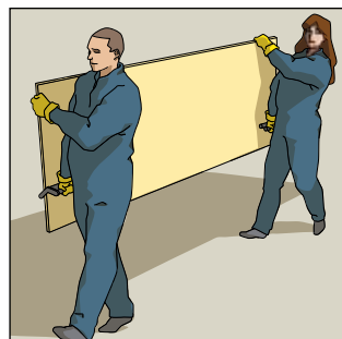
Glasroc-skivor bärs vertikalt. Bra hjälpmedel är Gyproc Bärhandtag.
