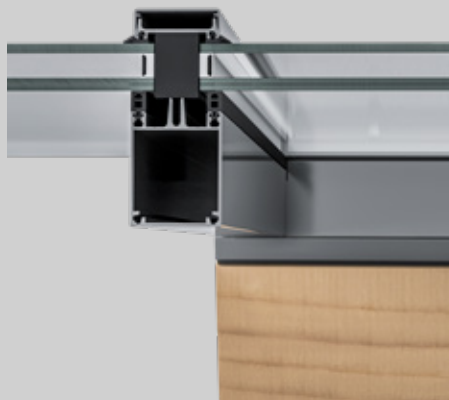
Fullt isolerad sarganslutning med tätskiktsmembran och runtomliggande takfotsplåt av 2 mm aluminium.
