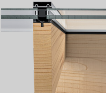
Fullt isolerad sarganslutning med tätskiktsmembran och runtomliggande takfotsplåt av 2 mm aluminium.
