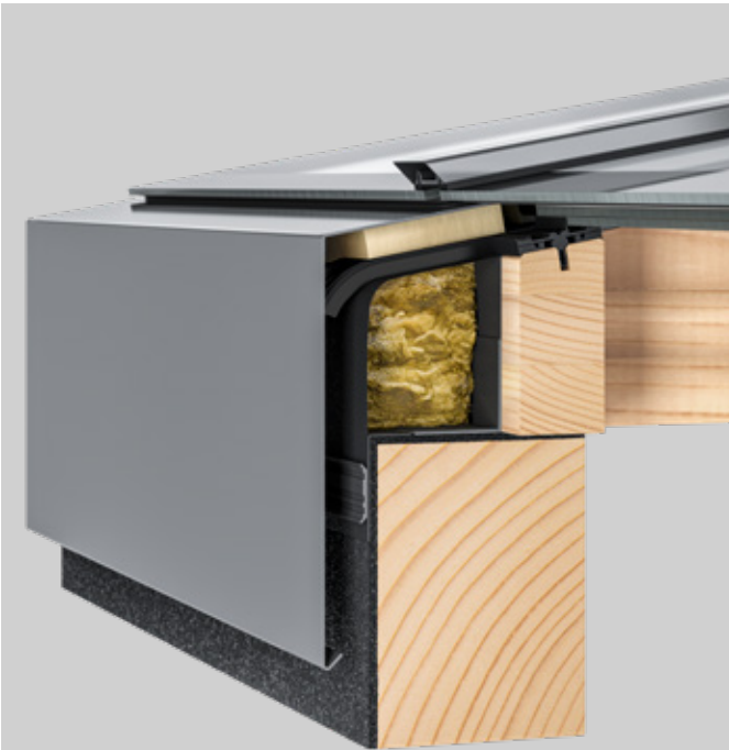
Fullt isolerad sarganslutning med tätskiktsmembran och runtomliggande takfotsplåt av 2 mm aluminium.
