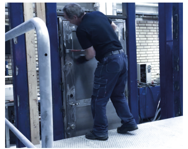
Bilden visar STEP 18 Secure monterat med Stålprofil i ett skarpt prov hos RISE.
