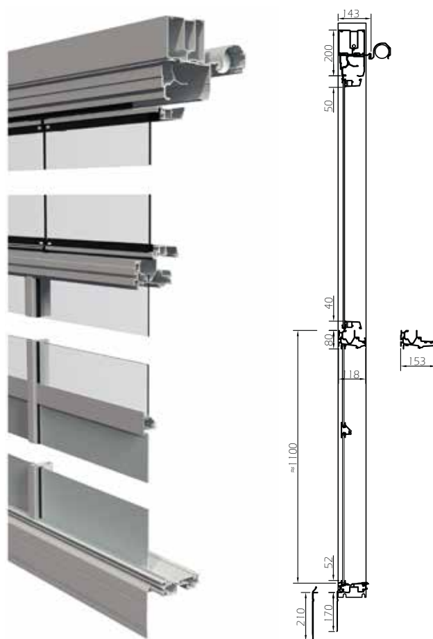
Design Sight. Tvärsnitt och ritning från sidan.
