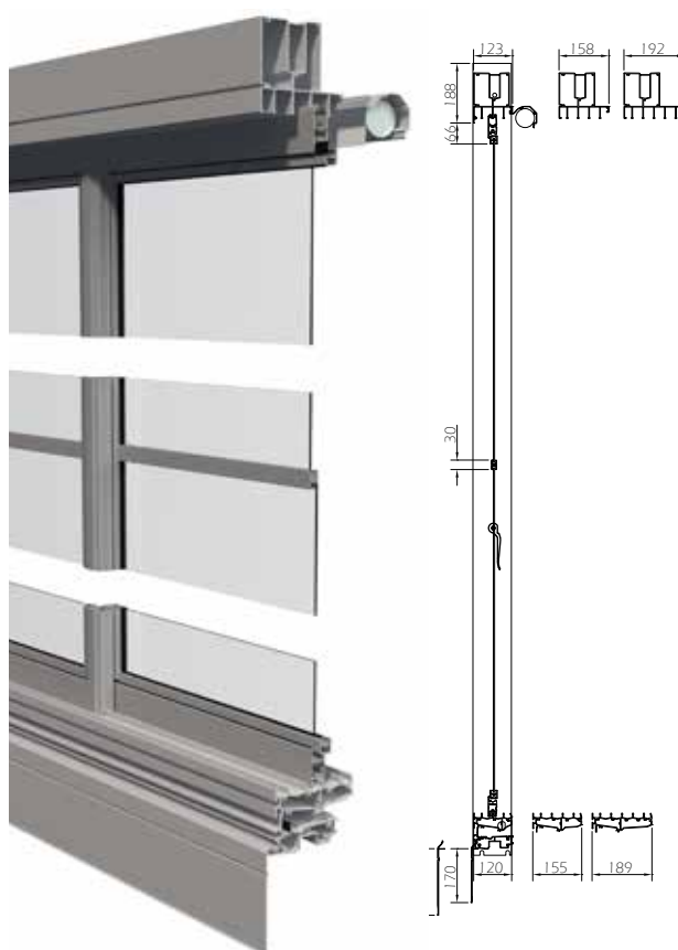
Twin våningshög. Tvärsnitt och ritning från sidan.
