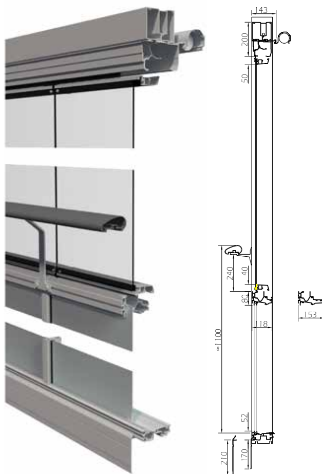
Design Air. Tvärsnitt och ritning från sidan.
