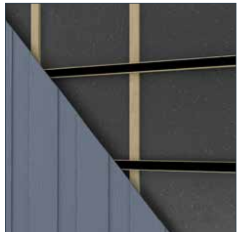
Montering stående på trä. Dubbelläktning krävs ej när luftad ställläkt används.
