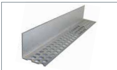
Cembrit Muslist Gnagarskydd vid fasadstart (Plank) för träläkt samt ovan fönster (Panel och Plank). Stål, magnelis, C5
