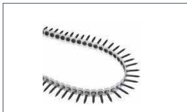
Cembit Rakbandad Skruv SCR-W 3,9x38 Härdat stål, ZYTEC GX, rakbandad. För dold montering på träläkt
