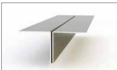
Cembrit T-list 25x30x30 mm lackerad aluminiumlist för lodrät sammanfogning av brädor
