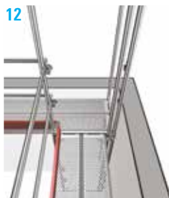
12 För en glipfri övergång i hörnområdet förskjuts ramarna med överhäng. Sidskyddet vid överhängande fack skapas med teleskopiskt räcke eller rör och kopplingar samt motsvarande lång sparklist.
