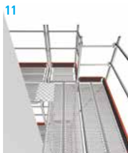
11 Breddningar på det översta planet kan göras om en svängbar och en fast konsol monteras mot spiran. På så sätt undviks ev. höjdskillnad i bomlagen.
