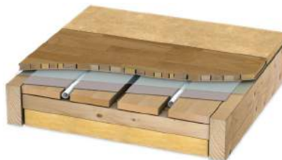
Bild: I träbjälklag
