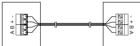
Bild: Termostat och reglercentral
