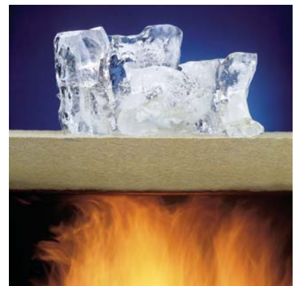
Stenull smälter inte ens vid brand. En konstruktion kan därför stå emot brand mycket längre, vilket kan förbättra räddningschansen och begränsa skador avsevärt.
