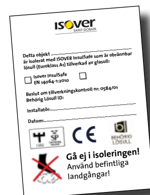
4.2 Skylt monteras efter installation.
