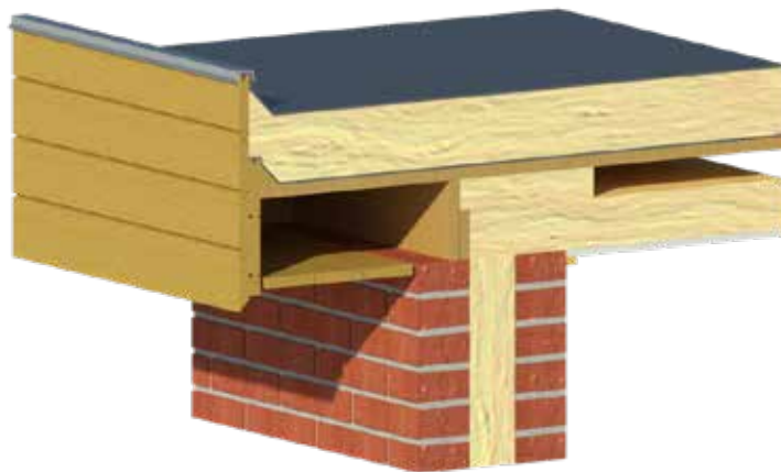
Fig. 18: Stängning av ventilationsöppningar vid tilläggsisolering.
