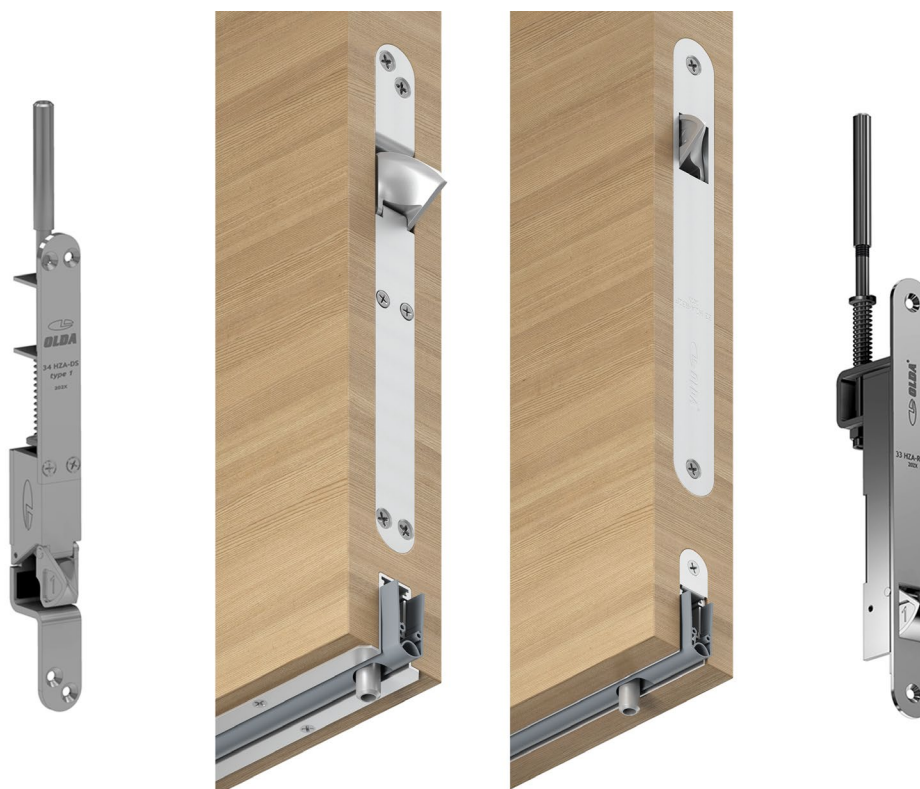
Bild 2: Olda kantreglar går utmärkt att integrera med automatiska tätningströsklar från Athmer med dess integrerade styrbleck för \varnothing 8 mm reglar. Till vänster i bilden visas 34 HZA-DS integrerat med Schall-Ex L-15/30 OS och till höger 33 HZA-R32F 8x60 integrerat med Schall-Ex L-15/30 WS.
