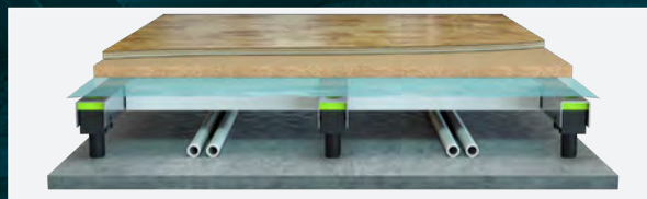
System 7000N med fuktspärr ovanpå reglarna.
