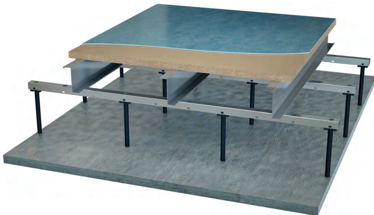
7000N hög höjd med Z-profil av stål + 38 mm spånskiva + matta
