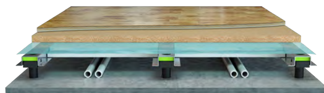
System 3000N med fuktspärr ovanpå reglarna.
