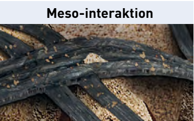
Meso-interaktion Interaktion mellan jordpartiklarna och geonätets ribbor på grund av ytstrukturen.
