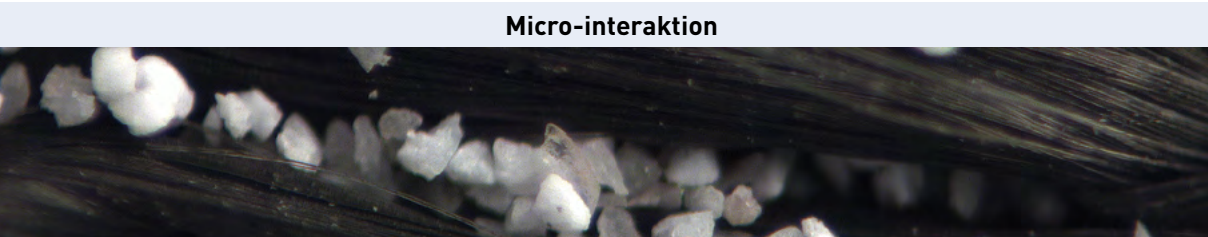
Micro-interaktion Synonym för friktion / vidhäftning: Mikroskopisk fastläsning av jordpartiklar med ytan på geonätet. Låsning mellan jordpartiklar och geonätets ribbor på grund av ytstrukturen.
