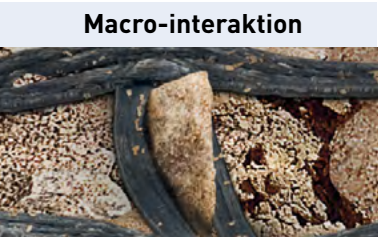
Macro-interaktion Genomträngning av stenar och grus genom öppningarna i geonätet, d.v.s. full förankring mellan jordpartiklar och geonätet.
