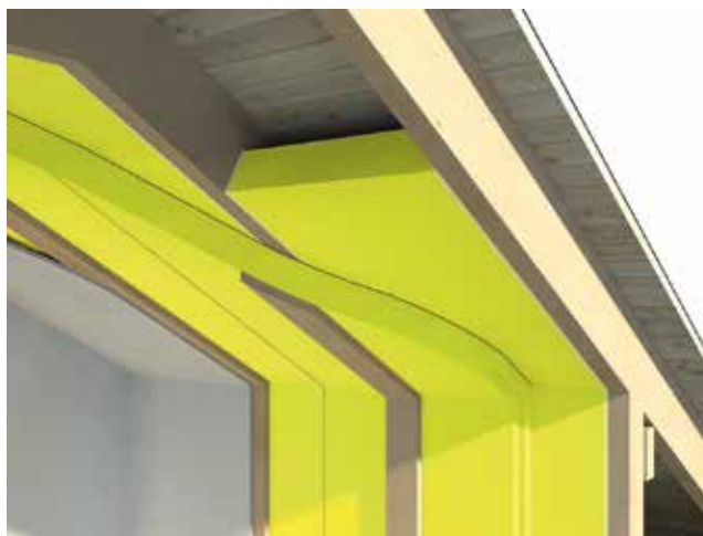
Isolering av sluttande tak med FF-EPS
