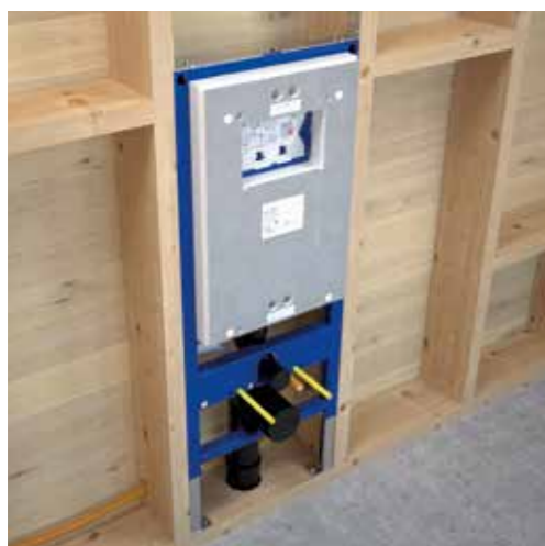
Ramen monteras med vinkeljärn i toppen och med skruvar mot golvregel, samt i de färdigborrade hålen i sidan på ramen mot stående regler.
